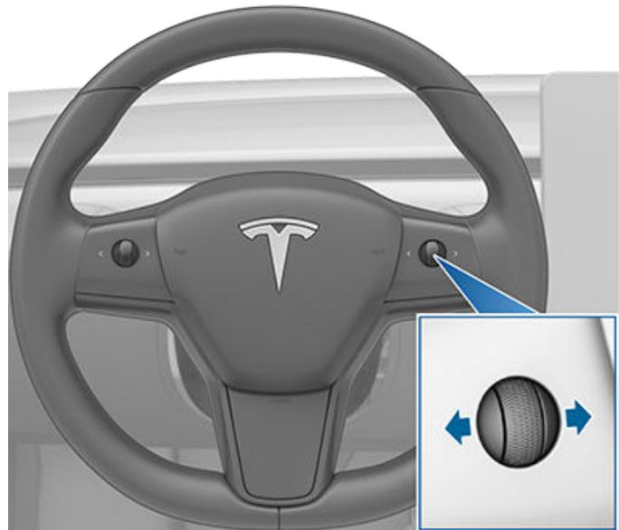
Jede Einstellung entspricht einem Zeitabstand, der angibt, wie lange Model Y von seiner aktuellen Position aus benötigt, um die Position der rückwärtigen Stoßstange des vorausfahrenden Fahrzeugs zu erreichen. Der Autopilot behält Ihre Einstellung bis zur nächsten Änderung bei.
