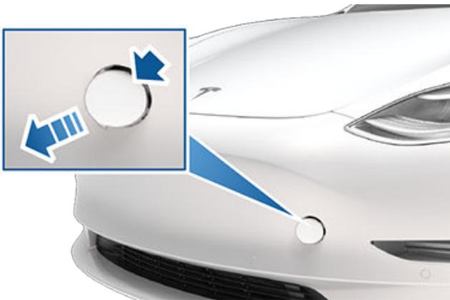
3. Ziehen Sie die zwei Kabel aus der Zugösenabdeckung, um die beiden Klemmen freizulegen.
