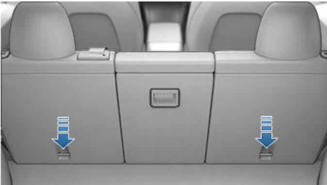
Stellen Sie sicher, dass der Haken vollständig in der Verankerung sitzt.
