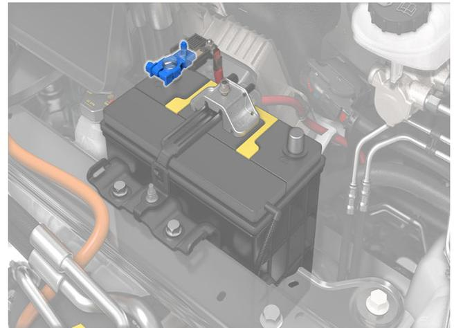
8. Trennen Sie den Entgasungsrohrschlauch von der Minuspoleseite (-) der Bleibatterie.
