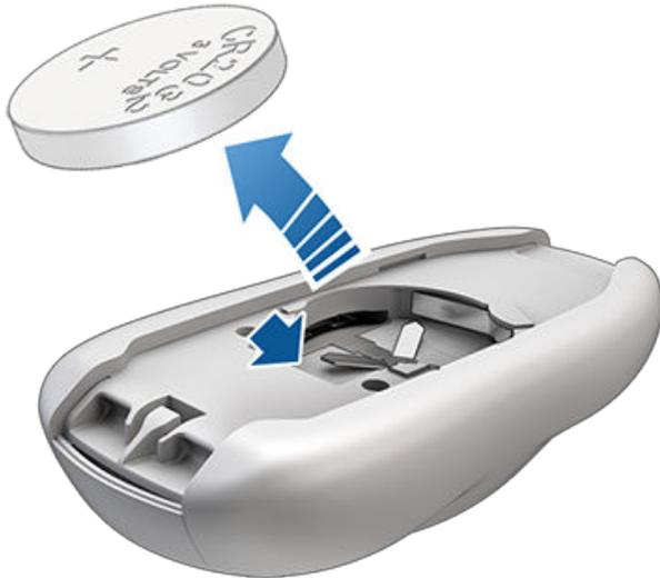
3. Vermeiden Sie es, die flachen Seiten der Batterie zu berühren, und legen Sie die neue Batterie (Typ CR2032) mit der „+“-Seite nach oben ein.
