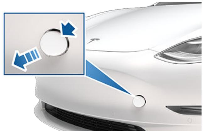
3. Setzen Sie die Zugöse in die Öffnung ein, und drehen Sie sie **nach links**, bis sie richtig sitzt.
