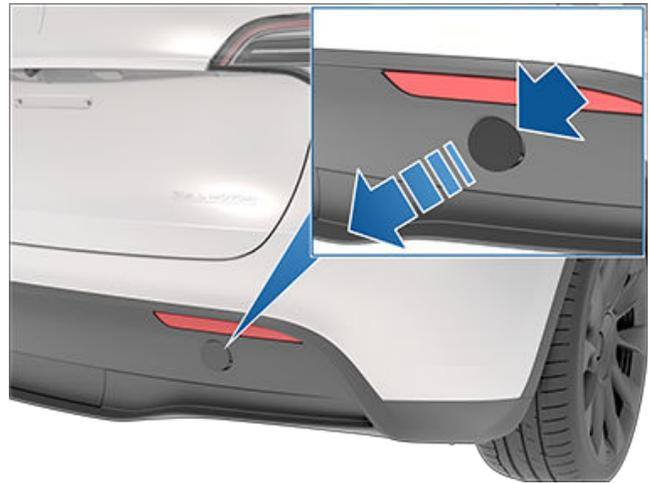
3. Setzen Sie die Zugöse in die Öffnung ein, und drehen Sie sie **nach links**, bis sie richtig sitzt.
