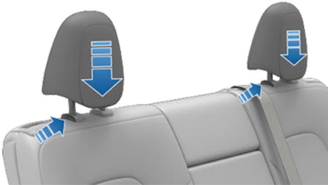
Für den mittleren Sitz der zweiten Reihe und für beide Sitze der dritten Reihe (sofern vorhanden) besteht die Möglichkeit, eine Kopfstütze anzuheben. Die Kopfstütze ist zunächst in der Rückenlehne untergebracht und kann nach oben gezogen werden.
