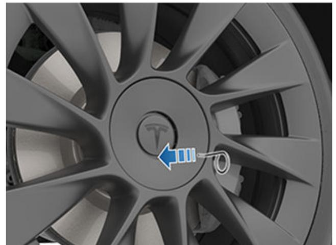
2. Drehen Sie das Radmutterabdeckungswerkzeug so, dass das Ende des gebogenen Teils vom Tesla-„T“ weg zeigt.
