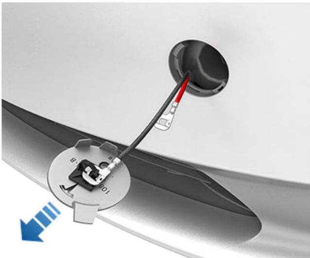
4. Schließen Sie das rote positive (+) Kabel der Niederspannung-Stromversorgung an der roten positiven (+) Klemme an.
