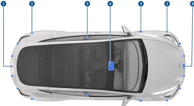
1. Eine Kamera ist oberhalb des hinteren Kennzeichens montiert.
