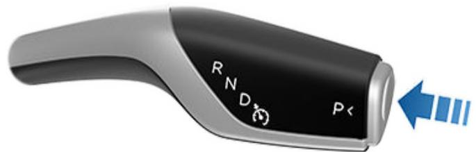
Model Y schaltet automatisch in den Parkmodus, um beim Fahren mit geringer Geschwindigkeit ein Wegrollen zu verhindern. Dies geschieht, wann immer Sie ein Ladekabel anschließen, den Sicherheitsgurt lösen oder die Tür öffnen, während sich das Fahrzeug im Fahr- oder Neutralmodus befindet. Stellen Sie sicher, dass das Ladekabel abgezogen ist, legen Sie den Sicherheitsgurt an, und schließen Sie die Tür, bevor Sie den Parkmodus deaktivieren.
