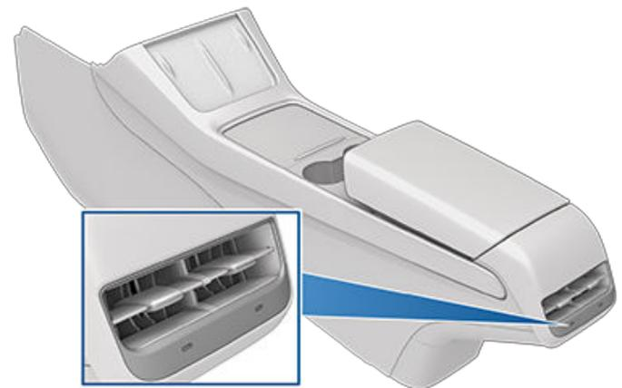
Wenn Model Y mit sieben Sitzen ausgestattet ist, befinden sich zwei USB-C-Anschlüsse an der Vorderseite der Konsole zwischen den Sitzen der dritten Reihe. Diese Anschlüsse können USB-Geräte aufladen, aber nicht mit dem Fahrzeug kommunizieren.
