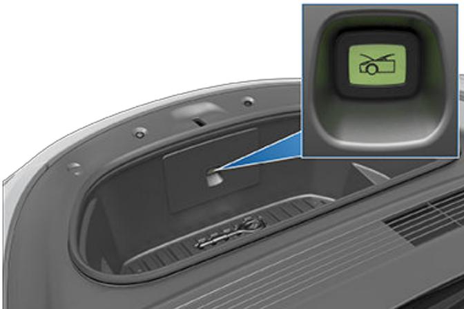
Drücken Sie die innere Entriegelungstaste, um den vorderen Kofferraum zu entriegeln, und drücken Sie dann die Haube nach oben.
