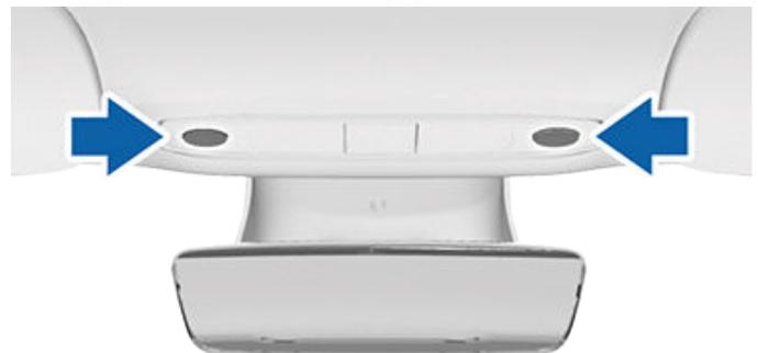
Sie können eine einzelne Deckenleuchte auch manuell ein- oder ausschalten, indem Sie auf deren Streuscheibe drücken. Manuell eingeschaltete Deckenleuchten erlöschen, wenn Model Y ausgeschaltet wird. Wenn Model Y beim manuellen Einschalten der Leuchte bereits ausgeschaltet war, erlischt diese schließlich.
