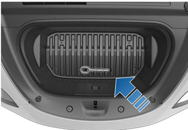
2. Entfernen Sie die hintere Zugösenabdeckung, indem Sie oben rechts kräftig auf den Rand der Abdeckung drücken, bis sie einklappt. Ziehen Sie dann vorsichtig den hervorstehenden Teil heraus.
