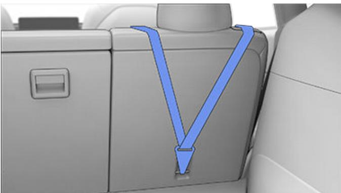
Führen Sie bei zweiträngigen Haltegurten in der zweiten Reihe je einen Gurt um je eine Seite der Kopfstütze.
