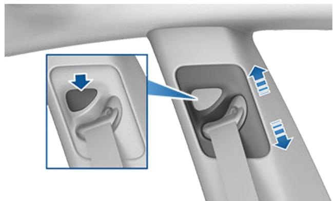
3. Lassen Sie den Knopf am Gurtumlenker los, sodass der Mechanismus wieder einrastet.
