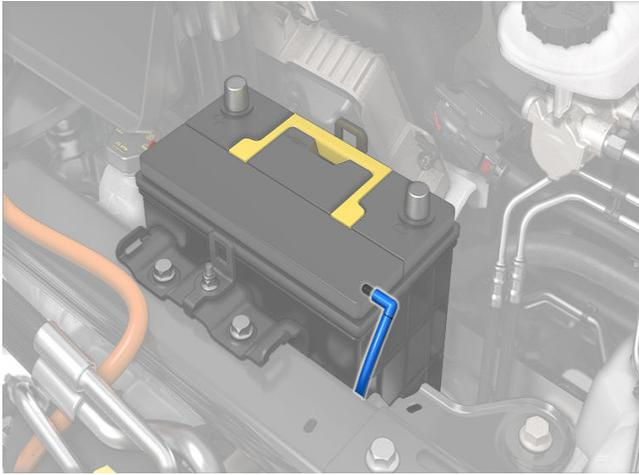
9. Lösen Sie die Mutter am Batterieniederhalter auf der Oberseite der Bleibatterie mit einem 10-mm-Steckschlüssel. Um den Batterieniederhalter zu lösen, haken Sie den Träger aus und schieben Sie ihn zurück. Kippen Sie den Batterieniederhalter bei Bedarf nach hinten, damit er nicht in das Fahrzeug rutscht.
