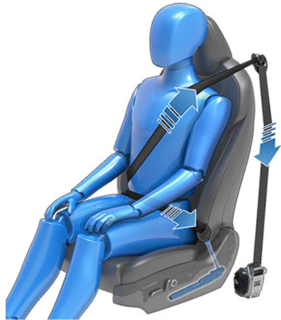
Wenn die Gurtstraffer und Airbags bei einem Zusammenstoß nicht auslösen, bedeutet dies nicht zwangsläufig eine Fehlfunktion. Es bedeutet in der Regel, dass die Größe oder Art der Kraft, die zum Auslösen erforderlich ist, nicht vorgelegen hat.
