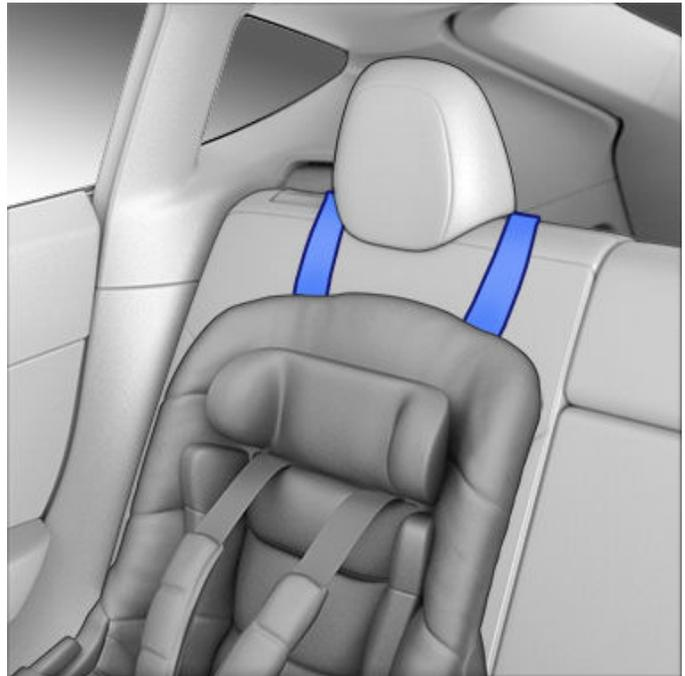
Führen Sie bei zweiträngigen Haltegurten in der dritten Reihe (sofern vorhanden) beide Gurte über die Kopfstütze.
