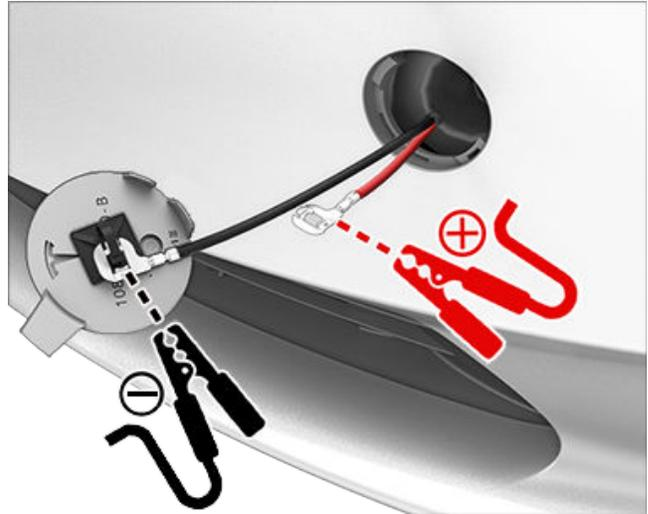
**ANMERKUNG:** Durch das Anschließen der externen Niederspannung-Stromversorgung an diese Klemmen lösen sich nur die Verschlüsse der Motorhaube. Sie können die Niederspannung-Batterie nicht über diese Klemmen aufladen. Lassen Sie die Niederspannung-Versorgungskabel nicht länger als 30 Sekunden mit den Anschlüssen verbunden – entfernen Sie sie von den Fahrzeuganschlüssen, sobald die Haube verriegelt ist.
