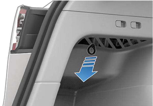
**ANMERKUNG:** Das Kabel zum manuellen Lösen ist möglicherweise in die Öffnung der Verkleidung eingelassen.
