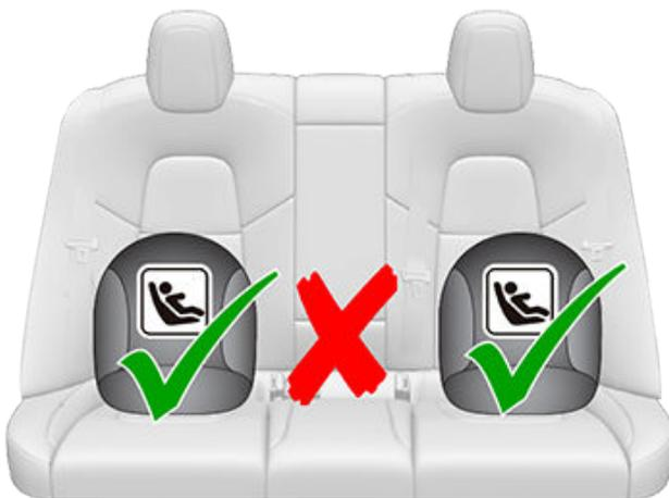
Beim Einbau eines ISOFIX-/i-Size-Kinderrückhaltesystems sollten Sie die Anweisungen des Herstellers des Kinderrückhaltesystems sorgfältig lesen und befolgen. Diese Anweisungen beschreiben, wie das Kinderrückhaltesystem auf die Verankerungen geschoben wird, bis es einrastet. Möglicherweise müssen Sie das Kinderrückhaltesystem fest gegen den Sitz drücken, damit es genau passt.
