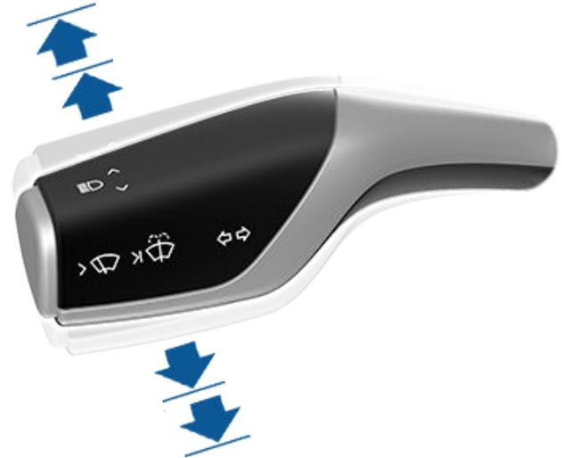
Der Blinker wird deaktiviert, wenn er vom Lenkrad abgeschaltet wird, wenn der Hebel in die entgegengesetzte Richtung bewegt wird oder wenn der Hebel ein zweites Mal leicht in dieselbe Richtung gedrückt wird.
