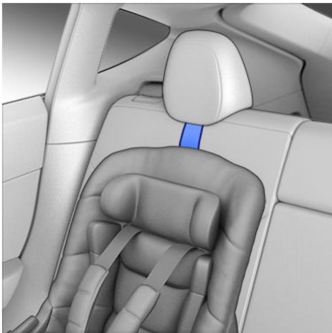
Führen Sie bei einsträngigen Haltegurten in der dritten Reihe (sofern vorhanden) den Gurt über die Kopfstütze.
