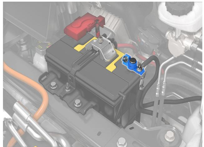
8. Schließen Sie den Entgasungsrohrschlauch in der Minuspoleseite (-) der Bleibatterie an.
