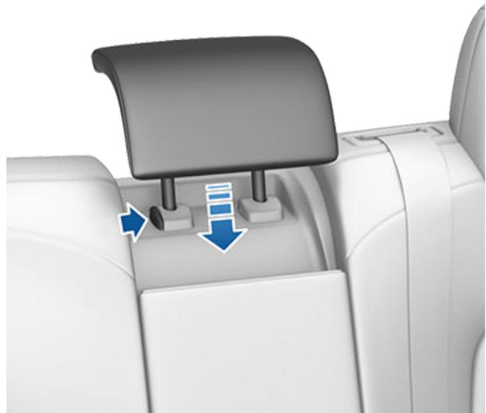
Um eine Kopfstütze in der dritten Reihe zu verstauen, drücken und halten Sie den Knopf unten an der Stange gedrückt, während Sie die Kopfstütze vollständig nach unten drücken.
