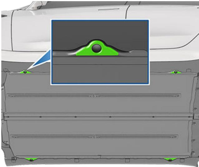
3. Stellen Sie die Höhe und die Position der Hubarmpolster so ein, dass diese richtig positioniert sind.
