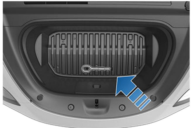
2. Entfernen Sie die vordere Zugösenabdeckung, indem Sie oben rechts kräftig auf den Rand der Abdeckung drücken, bis sie einklappt. Ziehen Sie dann vorsichtig den hervorstehenden Teil heraus.
