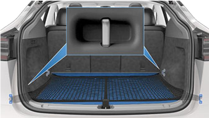
Model Y verfügt über vier Haken im hinteren Kofferraum (zwei im vorderen und zwei im hinteren Teil). Diese Haken sind dafür vorgesehen, mit den vier Ecken einer Verzurrvorrichtung, z. B. eines Gepäcknetzes, verbunden zu werden, um Gegenstände bei normalen Stadt- oder Überlandfahrten auf dem Boden des hinteren Kofferraums zu sichern. Weitere Informationen finden Sie in den Anweisungen des Herstellers der Verzurrvorrichtung.
