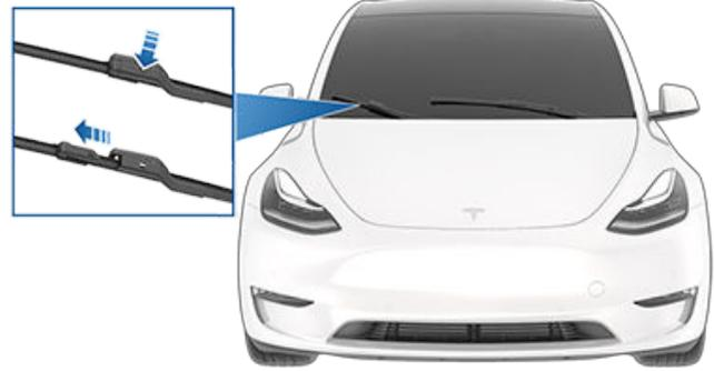
6. Richten Sie das neue Wischerblatt am Wischerarm aus, und schieben Sie es zum Ende des Wischerarms hin, bis es in seiner Position einrastet.
