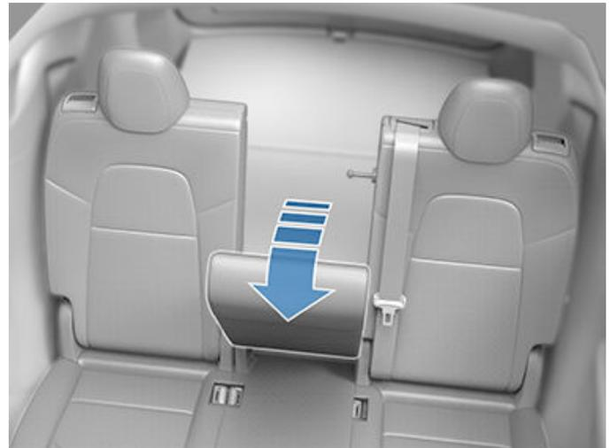
Außerdem können die Rückenlehnen in der zweiten Reihe vollständig nach vorne geklappt werden, indem der entsprechende Schalter auf der linken Seite im hinteren Kofferraum gedrückt wird. Durch Drücken des Schalters wird der Sitz nach vorne geschwenkt. Anschließend können Sie ihn herunterdrücken, bis er gerade liegt.
