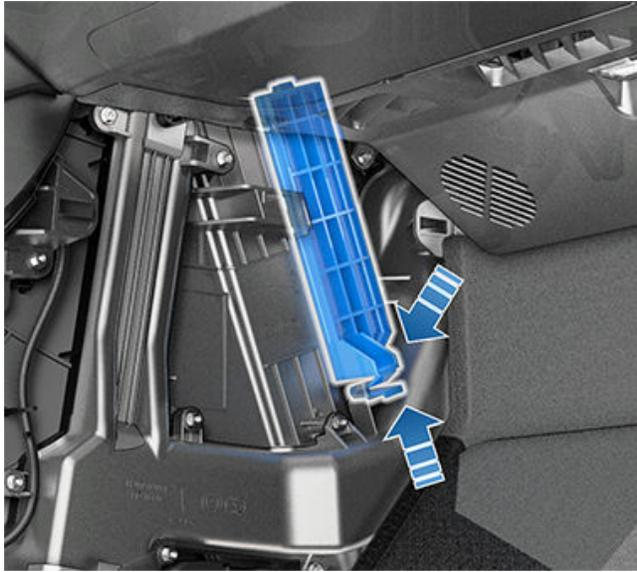
6. Klappen Sie die Laschen des oberen Innenraumfilters nach außen.
