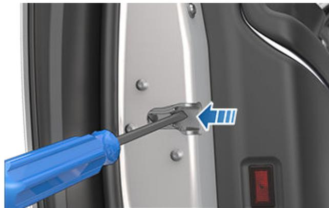
2. Model X がロックされていることを確認したら、エクステリアハンドルを押す、またはインテリアハンドルを引いてラッチをリセットしポップアクチュエーターを引き出します。
