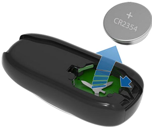
3. 電池の平らな面に触れないようにしながら新しい電池（CR2354 タイプ）を「+」側の面を上にして入れます。
