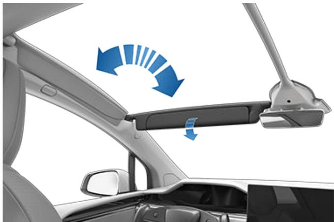
バニティ ミラーを使用するには、バイザー エクステンダーを下げてミラーカバーを下げます。カバーを下げると、ミラーが現れライトが点灯します。
