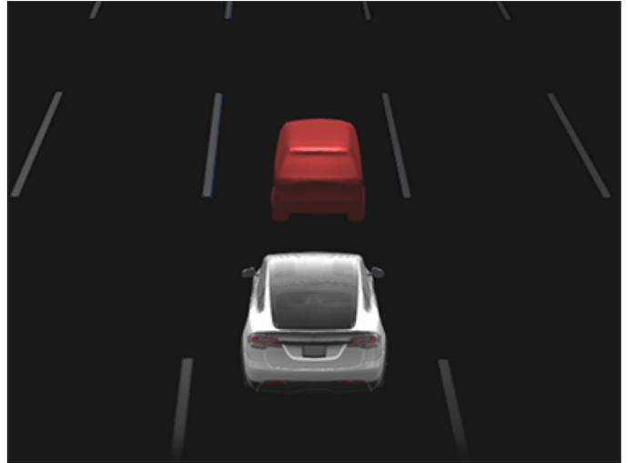
視覚および聴覚による警告は衝突の危険性が低くなったときに自動的に停止します (例えば Model X を減速または停止させた場合や、車両前方の物体が走行経路から外れた場合など)。
