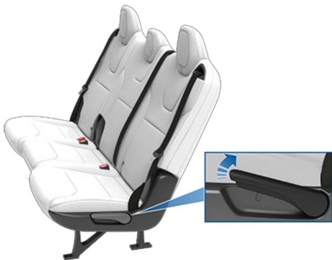
**⚠ 警告:** 走行中にリクライニングしたシートに座っていると、衝突時に乗員が腰ベルトの下に潜り込んだりシートベルトに巻き込まれたりして重傷を負う危険があります。車両走行時は必ず、人が座っているシートのリクライニングを 30°未満にしてください。
