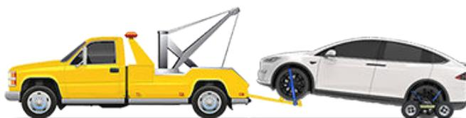
**注意:** 平ボディトラックに Model X をウィンチで載せる前に輸送モード（輸送モードの有効化 ページ 221 参照）を有効にしてください。輸送モードが使用できない、またはタッチスクリーンが利用できない場合は、必ずセルフローディングドリーまたはタイヤスケートを使用して、認定された輸送位置に車両を積載してください。Tesla は、セルフローディングドリーまたはタイヤスケートを使用した Model X の輸送が原因となる、個人財産の損害などのいかなる損害についても責任を負いません。
