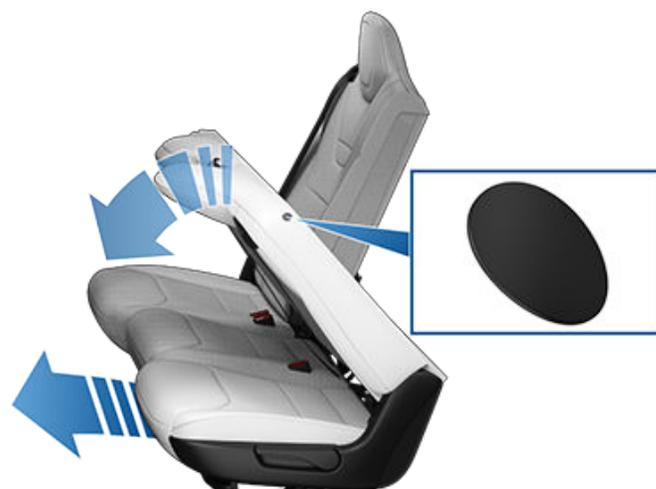
**警告:** 3列目のある車両では、お子さまを2列目に乗せているときに、2列目の窓際のベンチシートのバックレストにあるイーゼントリーボタンを使用しないでください。ボタンを使用すると、左側/中央一体型シートが前方に動いて傾き、乗員が圧迫されてしまう可能性があります。このボタンは、2列目シートに乗員がいないときのみ使用してください。運転前に、シートやシート背もたれがしっかりと固定されていることを確認してください。
