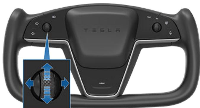
車両をリバースにシフトすると、両方の外側ミラーを自動的に下向きに傾けることができます。この機能のオンまたはオフを行うには、「コントロール」 > 「ミラー」 > 「ミラー角度自動調節」の順にタッチします。オートチルト位置を調整するには、「チルト位置の調整」をタッチし、必要に応じてミラーを調整してください。チルト位置を調整し「保存」をタッチすると、リバースにシフトするたびにミラーが設定された位置に自動で傾きます。ギアをリバース以外に戻すと、ミラーの角度はまた通常の位置（上方）へ戻ります。チルト位置を調整するには、「ミラー角度自動調節」を有効にする必要があります。
