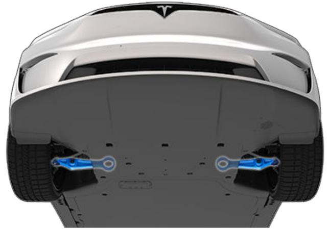
4. けん引ボルトにウィンチ ケーブルを取り付けます。
