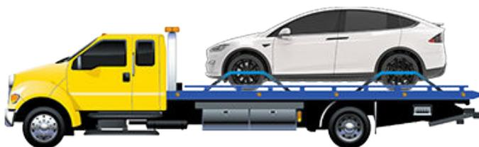
平ボディトラックを使用しないで Model X を輸送する必要がある場合は、タイヤスケートを使用してタイヤを地面から離してから輸送を開始してください。この方法は時速 55 km 以下で行い、絶対にタイヤスケートの製造元が指定する制限速度を超えてはなりません。この方法を使用する場合、Tesla はフロントタイヤを浮かせて、リアタイヤにタイヤスケートを履かせて車両を前向きすることを推奨しています。
