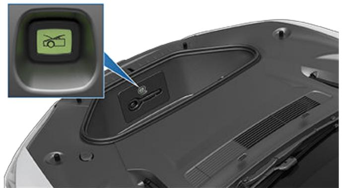
内部解除ボタンを押して、フロントトランクのラッチを解除し、ボンネットを押し上げます。
