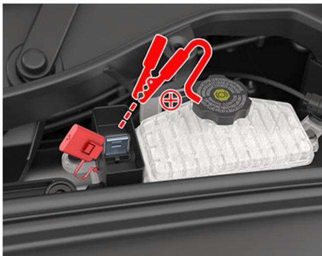
7. 低電圧電源の黒色のマイナス側ケーブルを図に示す位置で車両に接続します。
