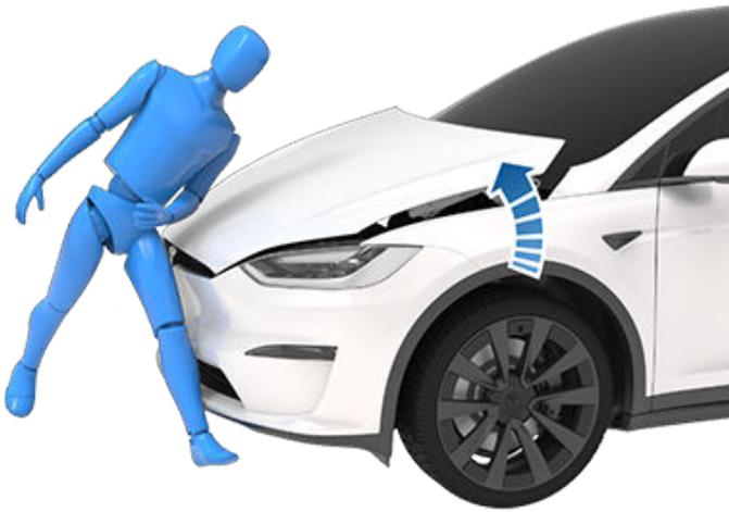
アクティブボンネットが作動したときは、インストゥルメントパネルに警告が表示され、チャイムが鳴ります。直ちに最寄りの Tesla サービスセンターまたは Tesla 認定ボディショップまで Model X を持ち込んでください。アクティブボンネットが作動した場合は、その都度アクティブボンネットの関連センサーおよびアクチュエーターを整備する必要があります。
