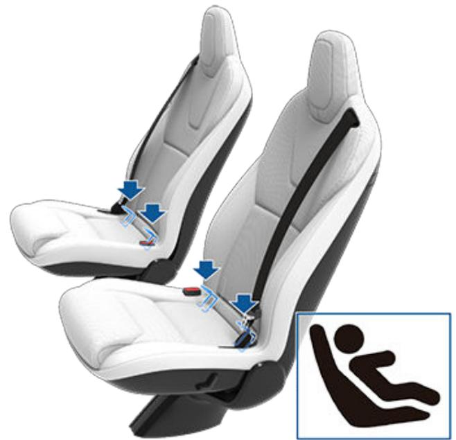
2列目は窓際座席の位置にだけ ISOFIX/iSize チャイルドシートを設置します。シート中央にはシートベルト保持式のシートだけを使用します。
