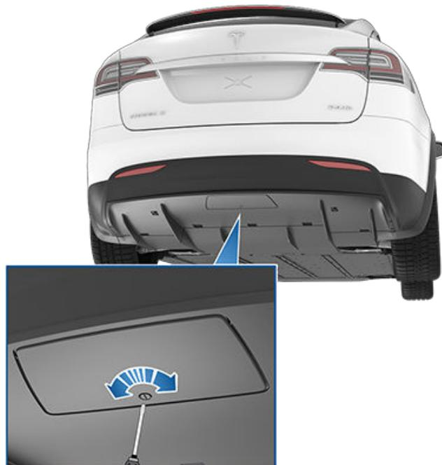
**注:** Model X では、プッシュクリップを 2 個使用してダストカバーを車両に固定します。開くには、マイナスドライバーなど先の尖った工具で慎重にクリップを開きます。ダストカバーを外します。
