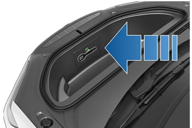
2. けん引ボルトカバーを取り外すには、小型のマイナスドライバーを上部および底部にあるスロットに差し込み、スナップを解除して、カバーを手前に引きます。
