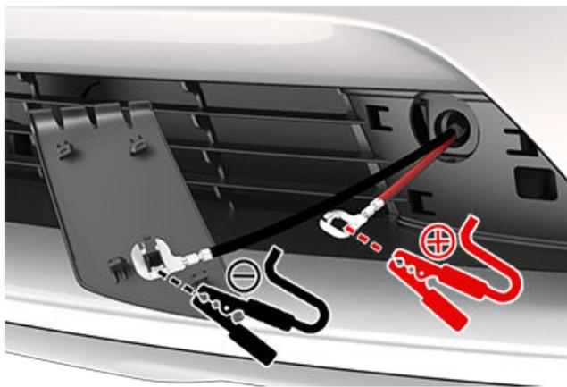
**注:** 外部低電圧電源をこれらの端子に接続するとボンネットのラッチのみリリースします。これらの端子を使用して低電圧バッテリーを充電することはできません。低電圧電源ケーブルを 30 秒以上端子に接続したままにしないでください。フードのラッチが掛かったら、直ちに車両の端子から取り外してください。
