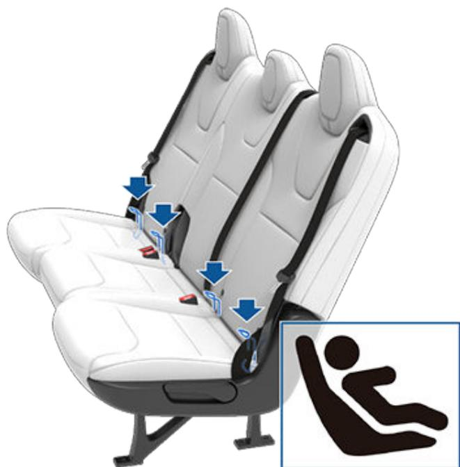
2列目は窓際座席の位置にだけ ISOFIX/iSize チャイルドシートを設置します。シート中央にはシートベルト保持式のシートだけを使用します。
