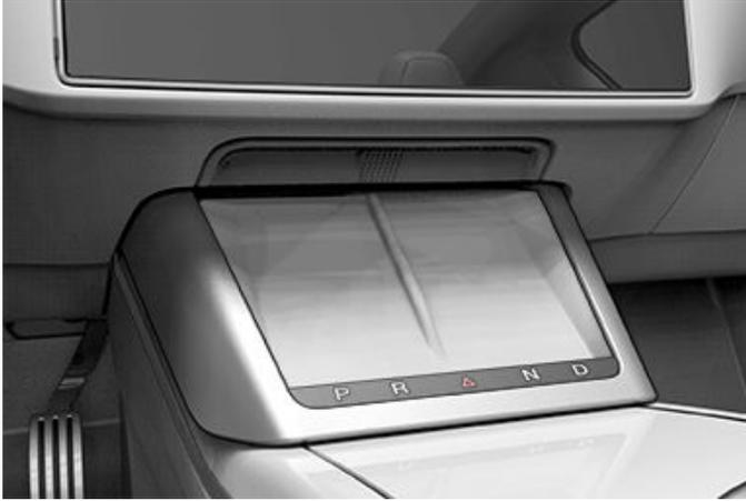
車両の電源が入っているとき（タッチスクリーンが有効で車内にいるとき）にお使いのスマートフォンをワイヤレス充電器に置くと、電話が充電されます。「エアコンをオンのままにする」、「ドッグモード」、「キャンプモード」、「セントリーモード」などの機能が有効になっていない限り、車から降りても電話機は充電されません。
