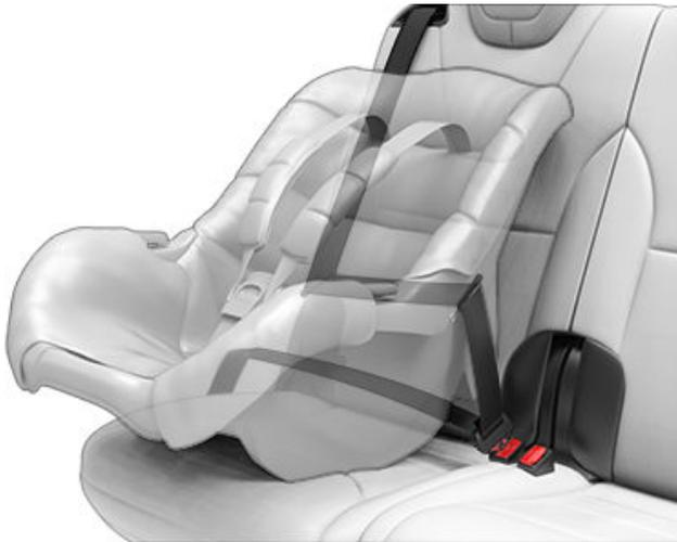
2. シートベルトを巻き取り、チャイルドシートを車両の座席にしっかり押し込みながらシートベルトの弛みを取り除きます。
