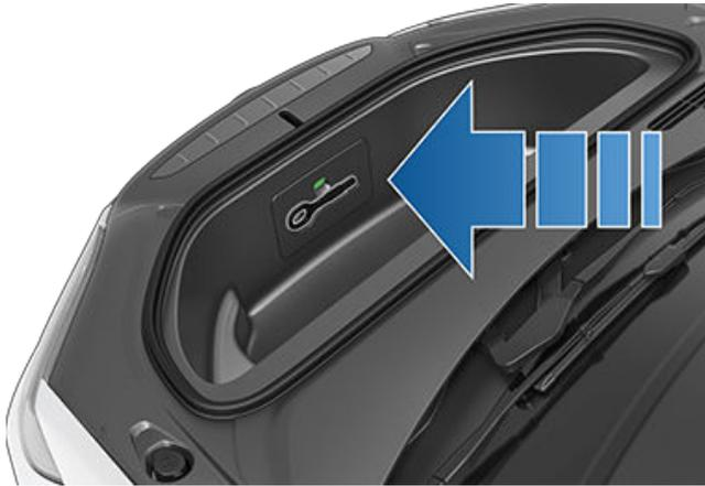
2. Pour retirer la protection de l'anneau de remorquage, insérez un petit tournevis plat dans les fentes supérieure et inférieure pour dégager les languettes, puis tirez la protection vers vous.
