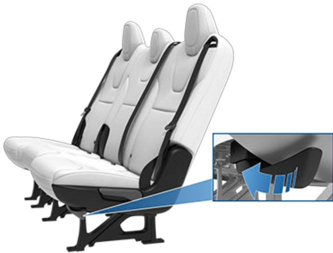
**REMARQUE :** Vous pouvez régler la position des banquettes uniquement à l'aide des leviers mécaniques. Vous ne pouvez pas utiliser l'écran tactile pour régler les banquettes arrière.
