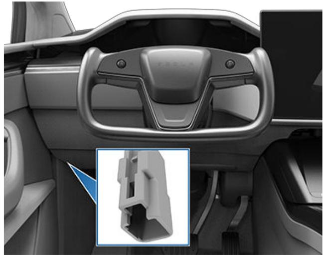
4. Branchez le connecteur à nattes sur le connecteur de câblage du véhicule.
