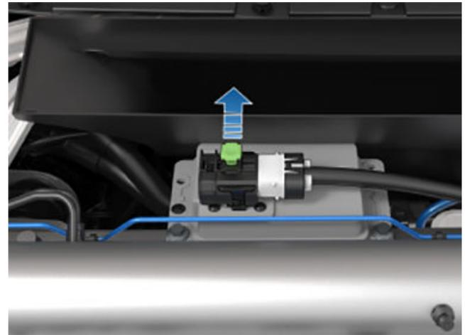
4. Sur le dessus de la batterie basse tension, tirez le boîtier de connecteur vers la gauche. Le connecteur électrique se détache de la batterie basse tension.
