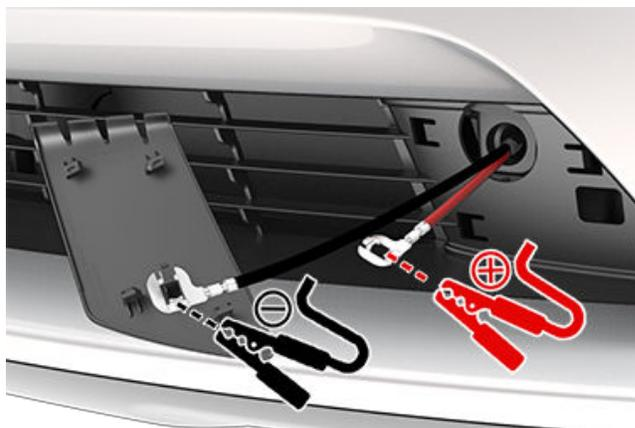
**REMARQUE :** Une alimentation basse tension externe transmise à ces bornes permet uniquement de déverrouiller les verrous du capot. Vous ne pouvez pas recharger la batterie basse tension à l'aide de ces bornes. Ne laissez pas les câbles d'alimentation de votre basse tension branchés aux bornes pendant plus de 30 secondes. Retirez-les des bornes du véhicule dès que le capot est verrouillé.
