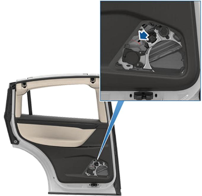
**ATTENTION :** Les déverrouillages de porte manuels sont conçus pour être utilisés uniquement lorsque votre Model X ne dispose pas de courant. Lorsque votre véhicule Model X est alimenté, utilisez le bouton situé sur la partie supérieure de la poignée de porte intérieure.
