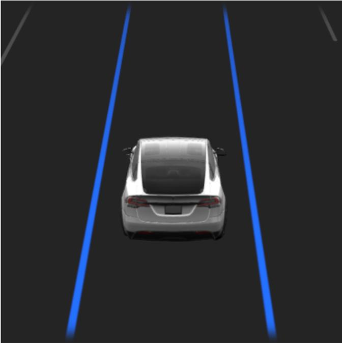
Si vous actionnez un clignotant alors que l'Assistance au maintien de cap est actif, votre Model X s'engage dans la voie adjacente dans la direction indiquée par le clignotant, si les conditions suivantes sont remplies :
