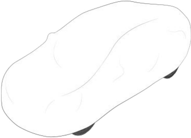
**!** **ATTENTION :** Si la Model X est branchée, utilisez uniquement une housse pour voiture agréée par Tesla. Utiliser une housse non agréée par Tesla peut empêcher le refroidissement adéquat de la batterie pendant la recharge.
