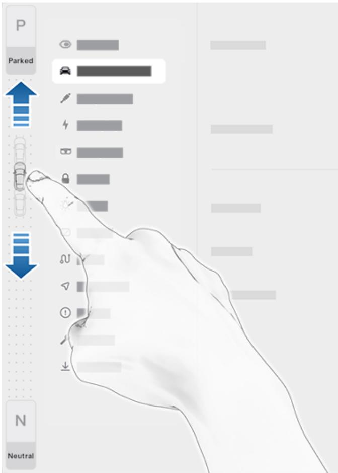
**REMARQUE :** Pour passer de la marche avant à la marche arrière et inversement, la vitesse de conduite doit être inférieure à 5 mph (8 km/h).
