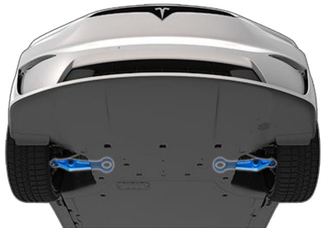
2. Pour protéger le soubassement de tout dommage, placez un élément (par exemple, un morceau de bois) entre les sangles et le soubassement.
