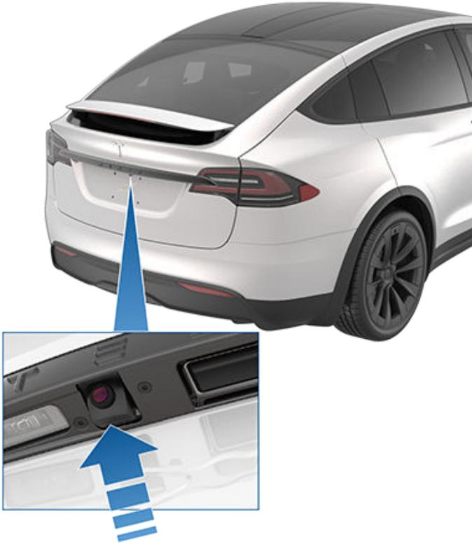
Si en marche arrière, un écran noir apparaît sur l'écran tactile au lieu de l'image de la caméra de recul, utilisez les rétroviseurs et assurez-vous que votre environnement ne présente aucun danger avant de poursuivre la marche arrière. Si le non-fonctionnement de la caméra de recul persiste, utilisez l'application mobile pour planifier un rendez-vous d'entretien.
