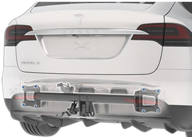
**REMARQUE :** Le porte-à-faux arrière maximal admissible pour le point d'attelage est de 47 pouces (1 186 mm).
