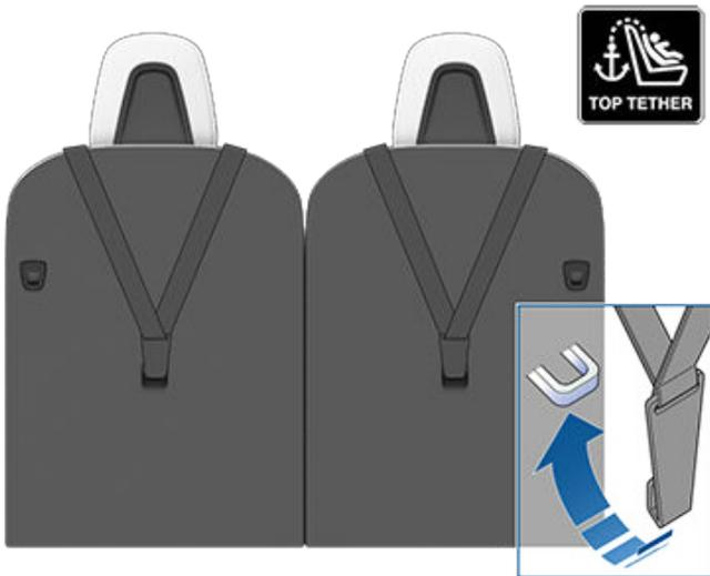
Positionnez les attaches à sangle unique au niveau des positions assises latérales de sorte à les faire passer au-dessus du côté extérieur de l'appuie-tête (du même côté de l'appuie-tête que le mécanisme d'enroulement de la ceinture de sécurité). Pour le siège central (le cas échéant), centrez et faites passer la sangle par-dessus l'appuie-tête.
