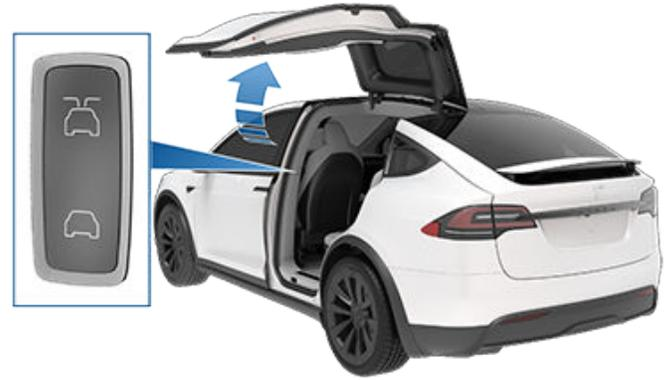
**REMARQUE :** Si le Model X est verrouillé, la première activation de l'interrupteur (illustration ci-dessus) déverrouille la porte concernée. La deuxième activation ouvre la porte.
