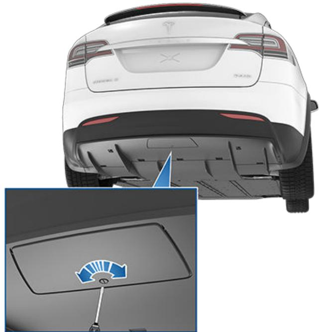
**REMARQUE :** Le Model X comporte deux agrafes poussoirs pour fixer la protection au véhicule. Pour les ouvrir, utilisez un objet tranchant tel qu'un tournevis à tête plate puis soulevez délicatement les agrafes. Retirez la protection.
