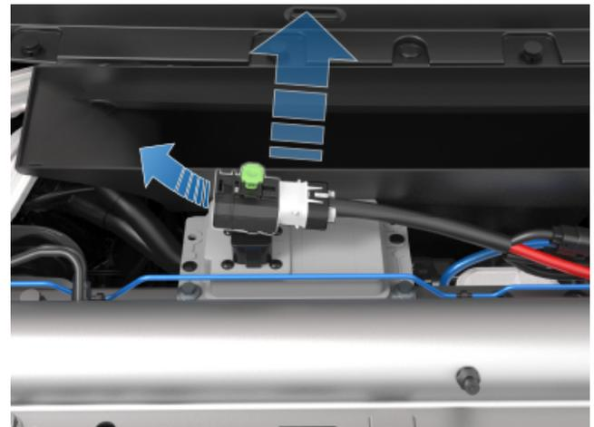
5. Placez un chiffon sec sur les éléments métalliques entourant le connecteur de la borne positive (+). Le connecteur de la borne se trouve sous le moteur d'essuie-glaces et le réservoir de liquide rectangulaire blanc.
