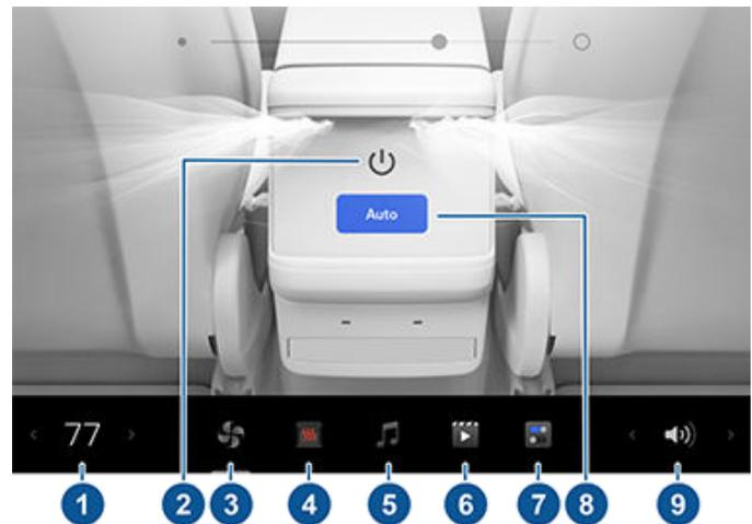
1. **Température :** appuyez sur les flèches pour diminuer/ augmenter la température de l'habitacle.
