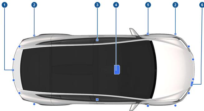
1. Une caméra est montée au-dessus de la plaque d'immatriculation arrière.
