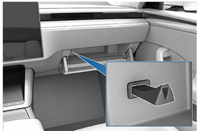
**REMARQUE :** L'alimentation est disponible lorsque le v hicule est utilis  ou d tecte la pr sence d'un utilisateur. Un utilisateur est consid r  comme pr sent lorsqu'une personne est assise sur le si ge conducteur ou interagit avec l' cran tactile. La batterie basse tension ne se d charge pas si un accessoire est laiss  branch .
