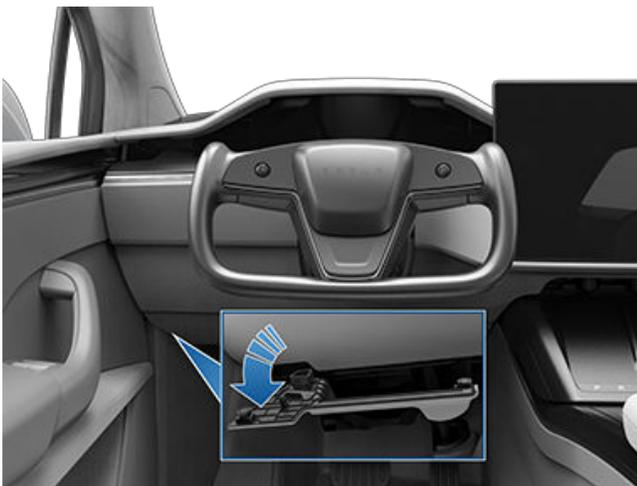
3. Relevez le tapis pour dégager le connecteur à quatre broches du faisceau de câblage du Model X.
