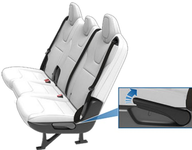
**⚠ AVERTISSEMENT :** La conduite d'un véhicule avec le dossier incliné peut entraîner des blessures graves en cas de collision, car vous risquez de glisser sous la ceinture sous-abdominale ou d'être projeté contre la ceinture de sécurité. Assurez-vous que le dossier des sièges occupés est incliné à 30 degrés au maximum lorsque le véhicule est en mouvement.
