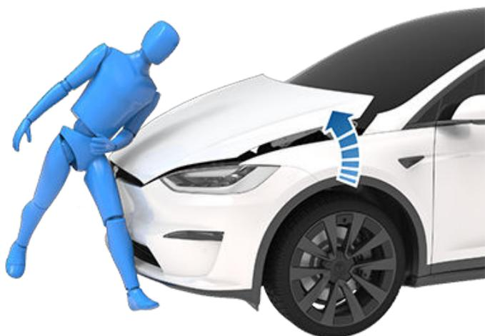
Si le Capot actif s'est déployé, une alerte visuelle s'affiche sur le tableau de bord et une alerte sonore se déclenche. Amenez immédiatement votre Model X au Service Center Tesla ou à l'atelier de carrosserie agréé Tesla le plus proche. En cas de déploiement du Capot actif, les capteurs et actionneurs doivent être remis en état.
