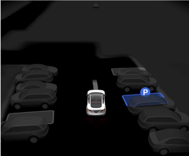
2. Déplacez la molette de défilement droite vers le haut ou vers le bas pour sélectionner une place de parking. Au moment de vous garer, appuyez sur le bouton de la molette de défilement droite et relâchez la volant Yoke (ou volant de direction).
