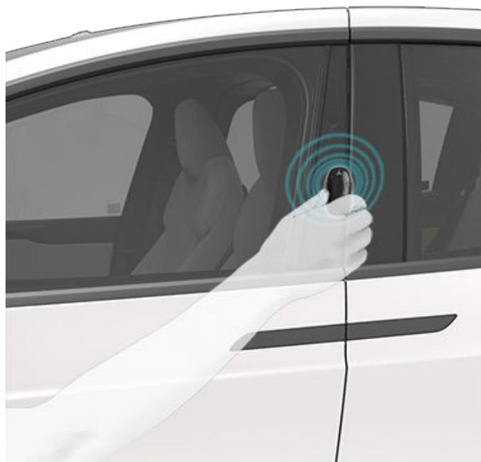
Pour conduire le véhicule, placez la clé sur le chargeur de téléphone.
