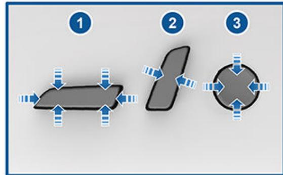
1. Faites avancer/reculer le siège et réglez sa hauteur ainsi que son angle d'inclinaison.
