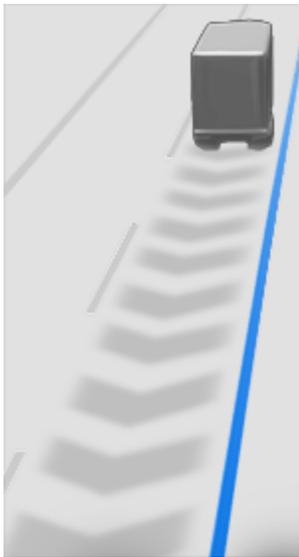
Lorsque vous suivez un véhicule, l'Autopilot reste actif à basse vitesse, y compris si votre Model X s'arrête. Par exemple, l'Autopilot reste actif même si votre Model X ralentit jusqu'à l'arrêt complet ou presque complet dans un trafic dense et en accordéon sur une autoroute. Lorsque le trafic commence à se fluidifier, l'Autopilot accélère à nouveau jusqu'à la vitesse définie.
