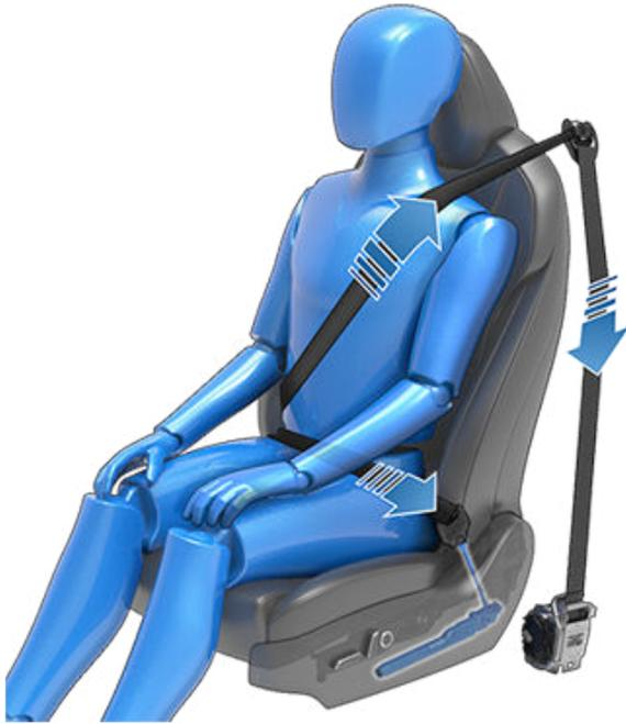
Si les prétendeurs et les airbags n'ont pas été activés lors d'un impact, cela n'est pas un signe de défaillance. Cela signifie généralement que l'intensité ou le type de force ne suffisaient pas pour les activer.
