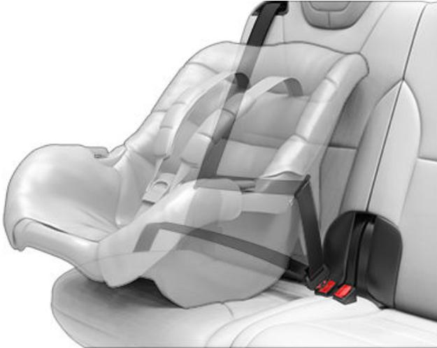
2. Laissez la ceinture de sécurité s'enrouler, et éliminez le jeu de la ceinture de sécurité tout en poussant fermement le siège de sécurité pour enfant dans le siège de votre Model X.
