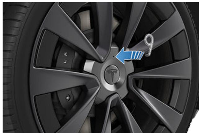
2. Utilisez l'outil du cache d'écrou de roue afin qu'il soit entièrement inséré dans le trou du cache d'écrou de roue.
