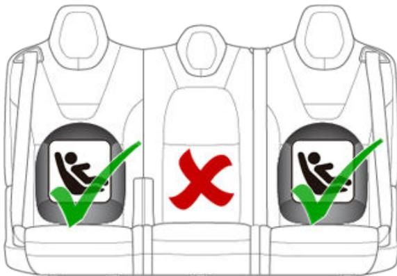
**REMARQUE :** Pour installer les sièges de sécurité pour enfants LATCH de grande taille orientés vers l'arrière, il vous faudra peut-être reculer complètement le siège et avancer le siège avant correspondant jusqu'en position intermédiaire (de 13 cm maximum par rapport à sa position la plus reculée), relever le siège (de 3 cm par rapport à sa position la plus basse) et l'incliner de 15 degrés vers l'arrière (ou 10 degrés vers l'arrière par rapport sa position la plus avancée).
