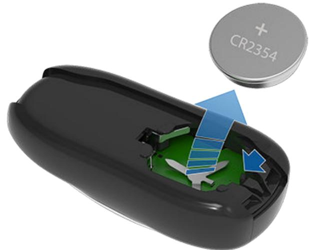
3. En évitant de toucher les surfaces planes de la pile, insérez la pile neuve (type CR2354), côté « + » orienté vers le haut.
