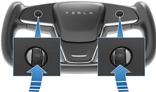
3. Au bout de quelques secondes, le logo Tesla apparaît. Attendez environ 30 secondes que l'écran tactile redémarre. Si l'écran tactile ne répond toujours pas ou si son comportement reste inhabituel au bout de quelques minutes, essayez de mettre le véhicule hors tension, puis de nouveau sous tension (si possible). Voir [Mise hors tension, puis sous tension du véhicule à la page 86](#).
