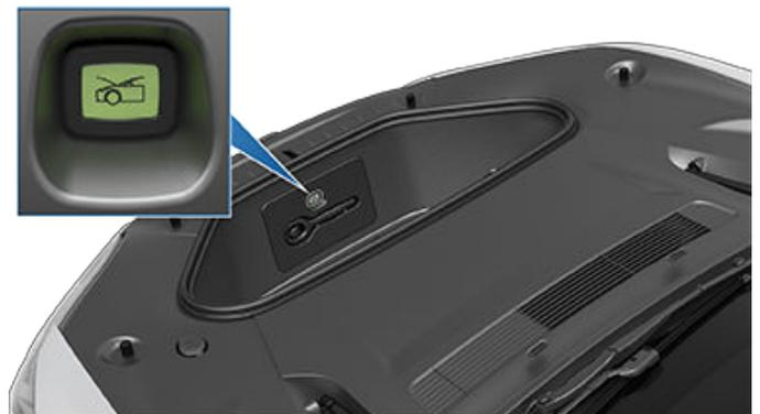
Appuyez sur le bouton de déverrouillage intérieur pour déverrouiller le coffre avant puis soulevez le capot.
