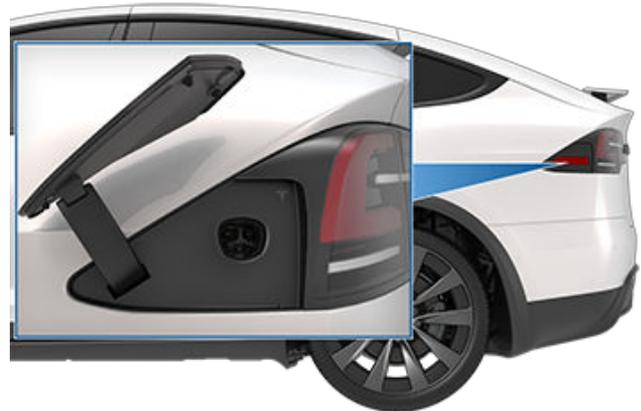
**REMARQUE :** Le témoin de la prise de recharge devient blanc lorsque vous ouvrez la trappe de la prise de recharge. Si vous n'insérez pas de câble de recharge dans la prise de recharge quelques minutes après avoir ouvert la trappe de la prise de recharge, la trappe de la prise de recharge se ferme. Dans ce cas, utilisez l'écran tactile pour ouvrir à nouveau la trappe de la prise de recharge.
