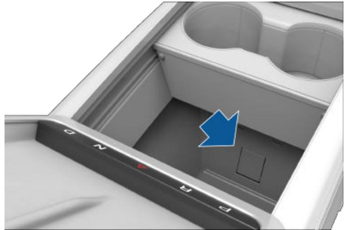
La prise de courant est adaptée aux accessoires nécessitant un courant continu allant jusqu'à 12 A (pic : 16 A).
