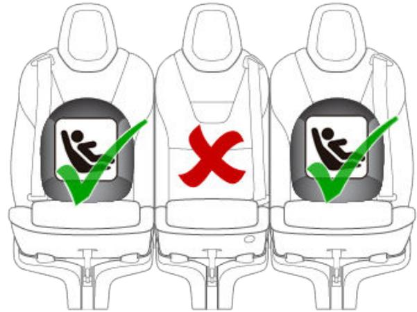
**REMARQUE :** Pour installer les sièges de sécurité pour enfants LATCH de grande taille orientés vers l'arrière, il vous faudra peut-être reculer complètement le siège et avancer le siège avant correspondant jusqu'en position intermédiaire (de 13 cm maximum par rapport à sa position la plus reculée), relever le siège (de 3 cm par rapport à sa position la plus basse) et l'incliner de 15 degrés vers l'arrière (ou 10 degrés vers l'arrière par rapport sa position la plus avancée).
