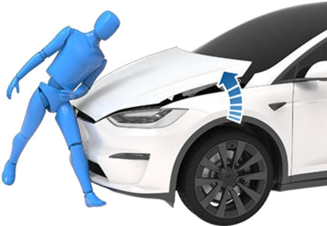
Nach Auslösung der aktiven Haube wird auf der Instrumententafel ein Alarm angezeigt und ein Ton ausgegeben. Bringen Sie Model X sofort zum nächstgelegenen Tesla Service Center oder zu einer von Tesla autorisierten Karosseriewerkstatt. Die zur aktiven Haube gehörenden Sensoren und Stellglieder müssen nach einer Auslösung der aktiven Motorhaube unbedingt überprüft werden.
