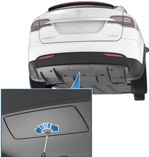
**ANMERKUNG:** Model X weist möglicherweise zwei Druckclips auf, mit denen die Staubschutzabdeckung am Fahrzeug gehalten wird. Wenn Sie die Kappe öffnen möchten, verwenden Sie einen scharfkantigen Gegenstand, z. B. einen flachen Schraubendreher, um die Clips vorsichtig herauszuhebeln. Entfernen Sie die Staubschutzabdeckung.
