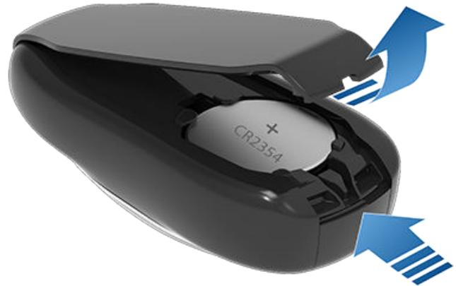
**ANMERKUNG:** Wenn der Schlüssel mit einem Schlüsselband versehen ist, können Sie die untere Abdeckung lösen, indem Sie den Daumen an das „X“ auf der unteren Abdeckung legen und dann das Schlüsselband fest zu sich hin ziehen (und so den Schlüssel von der Abdeckung schieben). Sie können die Abdeckung auch abhebeln, indem Sie ein kleines flaches Werkzeug, einen Fingernagel oder das von Tesla mitgelieferte Werkzeug am Schlüsselband ansetzen.
