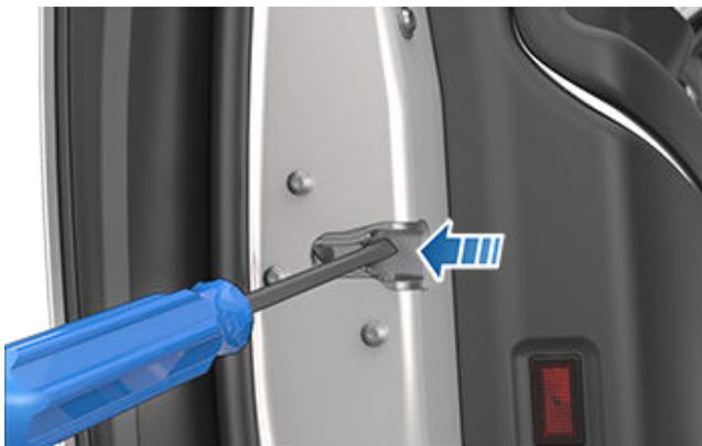
2. Stellen Sie sicher, dass Model X entriegelt ist, und drücken Sie den äußeren Türgriff, oder ziehen Sie den inneren Türgriff, um die Falle zurückzusetzen und das Pop-Betätigungselement auszufahren.
