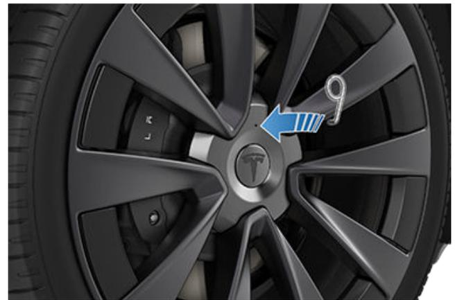
2. Drehen Sie das Radmutterabdeckungswerkzeug so, dass es sich vollständig in der Öffnung der Radmutterabdeckung befindet.
