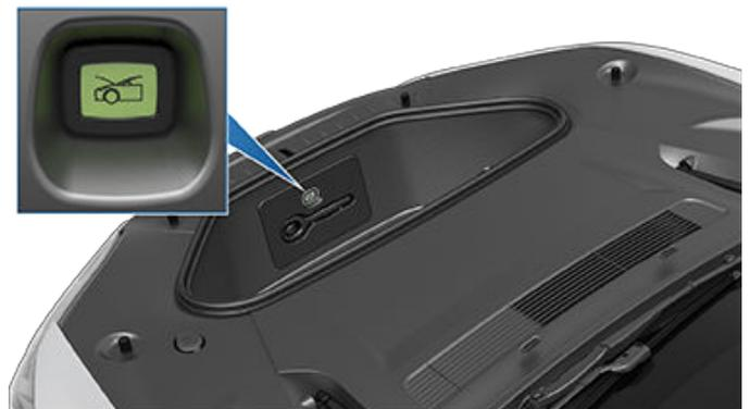
Drücken Sie die innere Entriegelungstaste, um den vorderen Kofferraum zu entriegeln, und drücken Sie dann die Haube nach oben.
