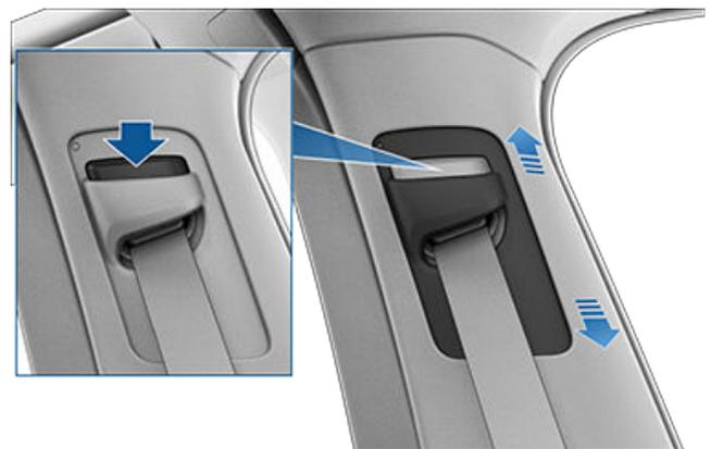
3. Lassen Sie den Knopf am Gurtumlenker los, sodass der Mechanismus wieder einrastet.
