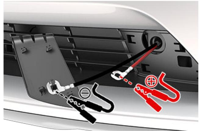
**ANMERKUNG:** Durch das Anschließen der externen Niederspannung-Stromversorgung an diese Klemmen lösen sich nur die Verschlüsse der Motorhaube. Sie können die Niederspannung-Batterie nicht über diese Klemmen aufladen. Lassen Sie die Niederspannung-Versorgungskabel nicht länger als 30 Sekunden mit den Anschlüssen verbunden – entfernen Sie sie von den Fahrzeuganschlüssen, sobald die Haube verriegelt ist.
