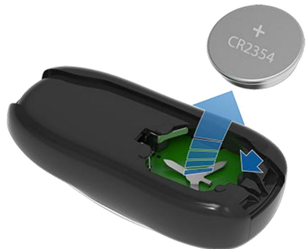
3. Vermeiden Sie es, die flachen Seiten der Batterie zu berühren, und legen Sie die neue Batterie (Typ CR2354) mit der „+“-Seite nach oben ein.
