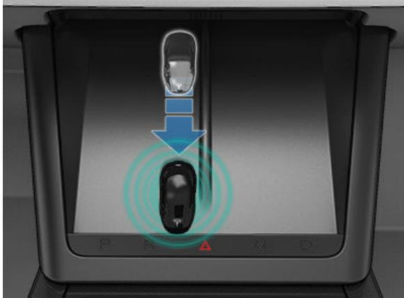
3. امسح بطاقة المفتاح أو سلسلة المفاتيح التي تم إقرانها بالفعل بالسيارة لتأكيد اقتران المفتاح الجديد.
