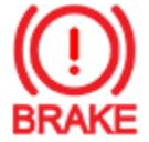
تعرض لوحة أجهزة القياس مؤشر مكابح التوقف ذا اللون الكهربائي هذا إذا اكتشف عطل في معزز المكابح. اضغط بصورة ثابتة وواصل الضغط على المكابح بقوة لإيقاف السيارة عندما يكون ذلك آمناً. ستكون ميزة تعويض فشل تعزيز المكابح الهيدروليكية نشطة (راجع تعويض فشل تعزيز المكابح الهيدروليكية في الصفحة 78).
