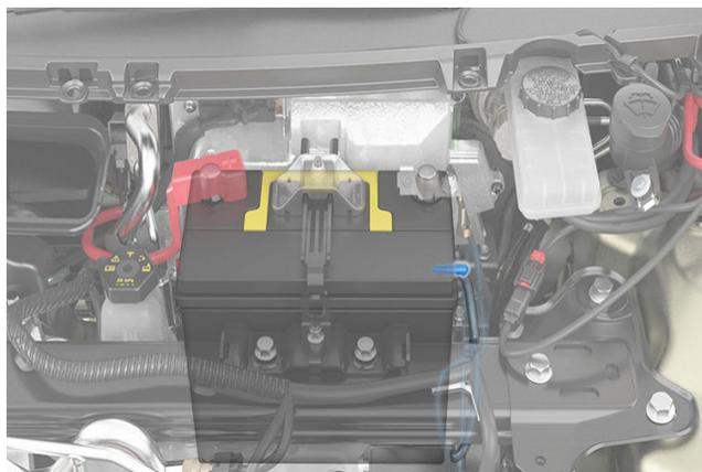
9. 使用 10 毫米插槽，鬆開螺母並從低壓鉛酸電池頂部鬆開電池壓制支架，方法是將其鬆開並滑回。如有需要，請向後傾斜電池壓制支架，使其不會滑入車內。
