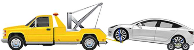
**警告：** 啟用運輸模式（請參閱 [啟動運輸模式](#) 在第 203 頁），然後才將 Model 3 吊到平板拖車上（請參閱 [拖至平板拖車上](#) 在第 204 頁）。如果無法使用運輸模式或觸控式螢幕，則必須使用自動裝載推車或輪胎滑板將車輛裝載到批准的運輸位置。對於因運送 Model 3 或運送期間造成的任何損壞，包括因使用自動手推車或輪胎滑板造成的個人財物等損失，Tesla 概不負責。
