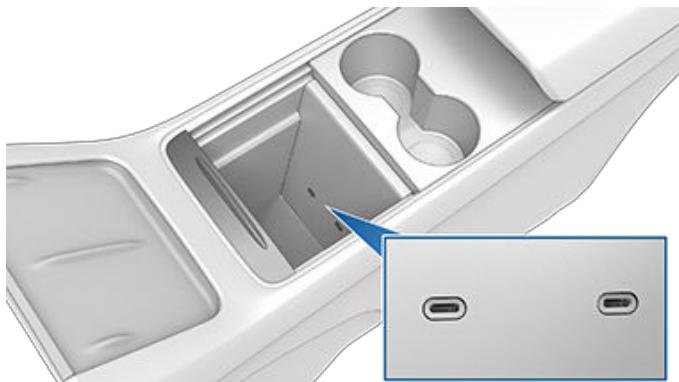
視乎生產日期而定，部分車輛的手飾箱內可能有 USB 連接埠。此 USB-A 連接埠配備已預先格式化的快閃磁碟機，可在使用哨兵模式和行車記錄儀等功能時隨時儲存影片。此連接埠還可用於與車輛通訊，以及為連接 USB 的裝置充電（但並非其主要用途）。
