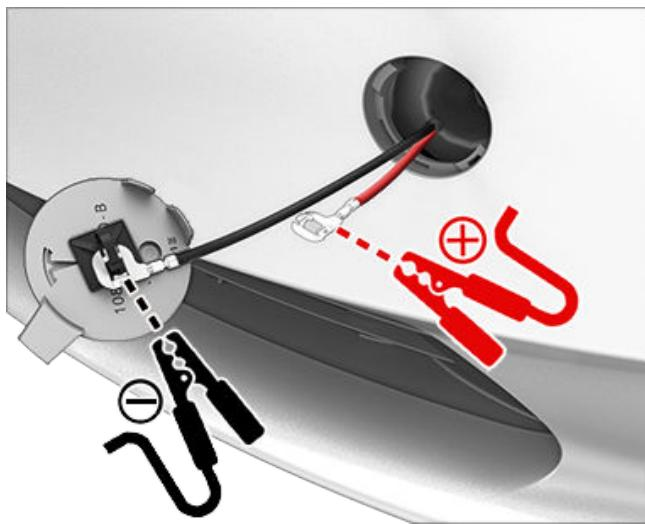
**注：**僅將此等終端接入外部低壓電源可鬆開頭凹門鎖。你無法利用此等終端給低壓電池充電。切勿將連接到終端的低壓電源纜線放置超過 30 秒，頭凹門鎖後應立即從車輛終端上拔除。
