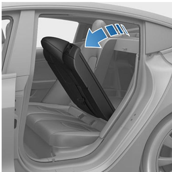
**警告：** 請勿拆除後排座椅，儲存或放置物品。這樣會暴露低壓和高壓接線點，可能導致車輛損壞或人員嚴重傷害。
