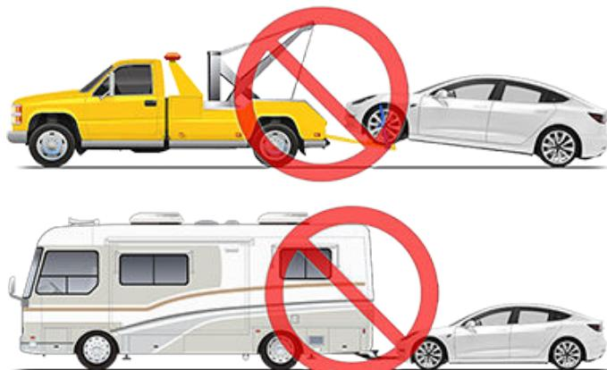
不要使用 Tesla 未指定的任何方法運輸 Model 3。請遵守以下部分中提供的說明，並注意所提供的所有警告和注意事項。因不恰當運輸你的車輛所造成的損壞不在保養範圍內。
