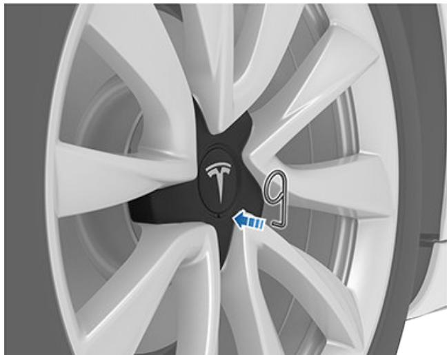
2. 操縱凸緣螺母蓋裝卸工具，將其完全插入凸緣螺母蓋的小孔內。
