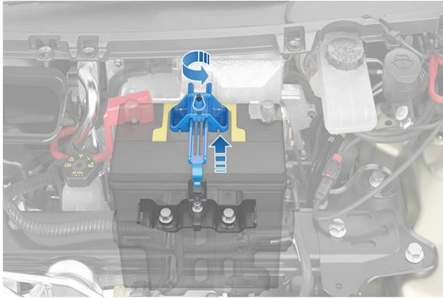
10. 小心取出低壓鉛酸電池，注意不要損壞周圍組件。
