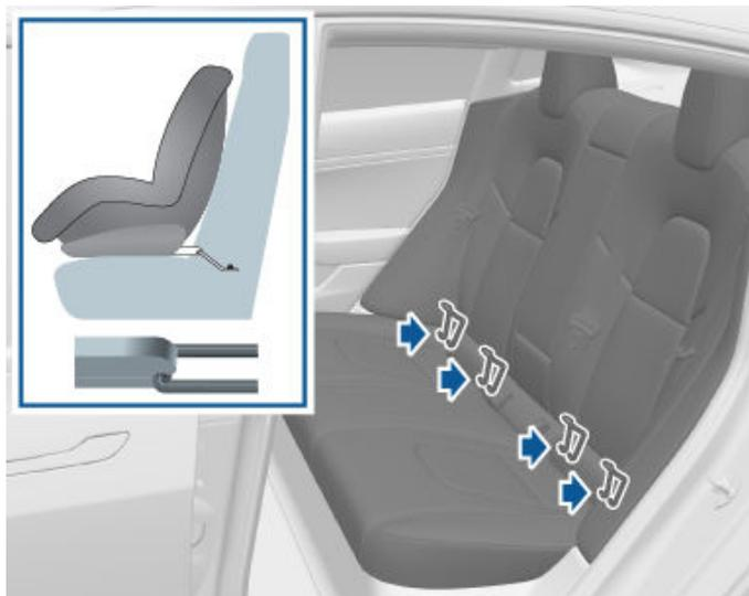
安裝後，須在兒童乘坐前測試裝置的安全性。嘗試將兒童安全座椅從一側向另一側扭動，並嘗試將其拉離座位，然後，檢查並確保固定器仍然固定到位。
