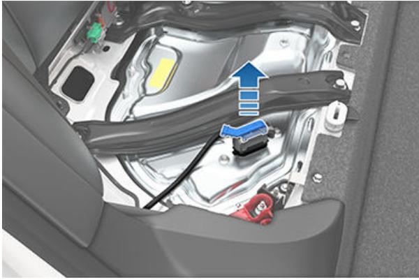
**⚠ 警告：** 座墊下方的區域裝有高壓電池。請勿在觸摸金屬外殼或在上方放置物品！這樣做可導致嚴重機件損壞或人身傷害。
