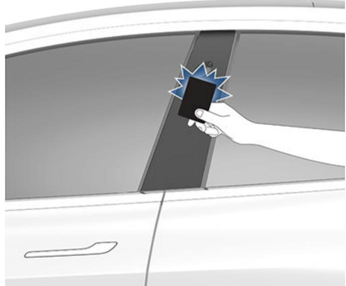
進入車內後，請在感應鑰匙卡後兩分鐘內踩下煞車腳踏以啟動 Model 3（請參閱 [啟動及關閉電源 在第 頁 56](#)）。若等待超過兩分鐘，則需重新驗證，此時請將卡片車匙放在中控台杯架後方的讀卡機附近。車輛偵測到鑰匙卡後，會重新開始兩分鐘的驗證等待時間。
