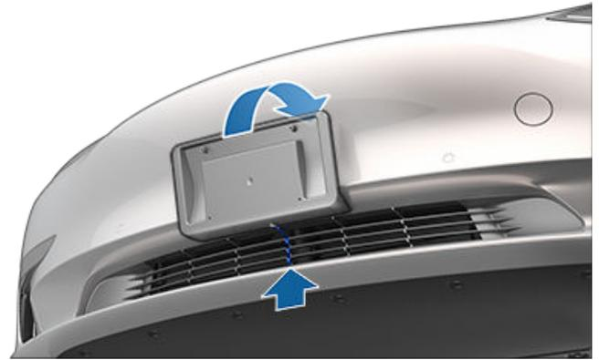
6. 清除支架各側剩餘膠帶，然後用力將整個支架壓在保險桿上，確保透過所有粘合區域將支架固定到位。
