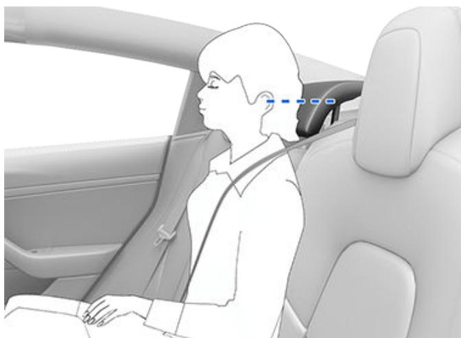
**警告：** 請確保在落座或駕駛 Model 3 前，將頭枕置於正確位置，一旦發生碰撞，可將重傷或死亡風險降到最低。落座後排中央座椅之前，請確保將頭枕升高並鎖定到位。
