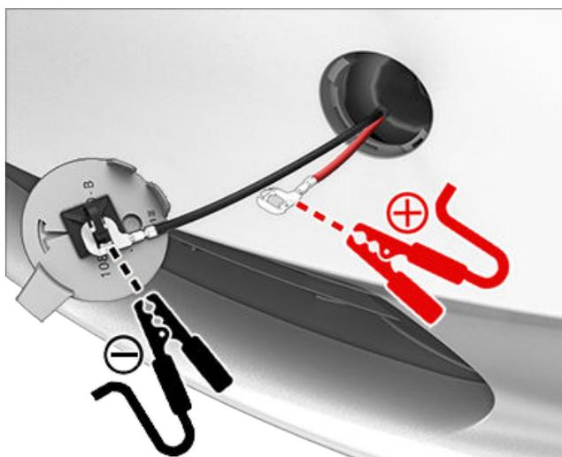
**注：**僅將此等終端接入外部 低壓 電源可鬆開頭罩門鎖。你無法利用此等終端給 低壓 電池充電。切勿將連接到終端的 低壓 電源纜線放置超過 30 秒，頭罩門鎖後應立即從車輛終端上拔除。
