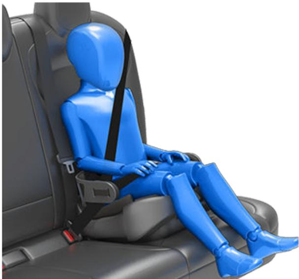
**警告：** 如果坐在增高椅上的體型較大的兒童，則應以與大人同樣的方式佩戴座椅安全帶。請勿完全拉出座椅安全帶織帶，以便啟動自動鎖緊式伸縮裝置（ALR）。
