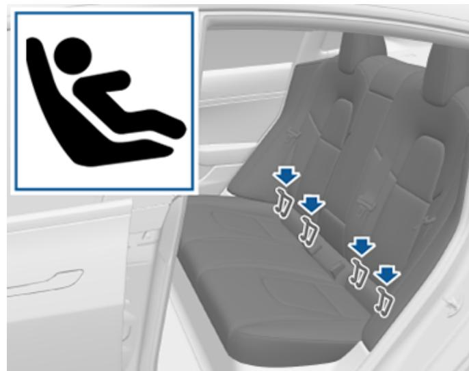
於第二排，僅在外側座椅位置安裝門鎖兒童安全座椅。僅可於中座使用安全帶固定式座椅。
