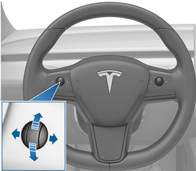
車輛切換至倒車檔時，兩個外後視鏡均可向下傾斜。若要開啟或關閉此功能，請輕觸控制 > 後視鏡 > 後視鏡自動傾斜。若要調整自動傾斜位置，請輕觸調整傾斜位置，根據需要調整後視鏡。調整過傾斜位置並輕觸儲存後，當你轉入倒車檔時，後視鏡將自動傾斜至設定的位置。離開倒車檔時，傾斜的後視鏡會復位至正常（向上）位置。須啟用後視鏡自動傾斜方可調整傾斜位置。
