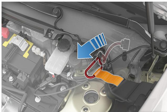
7. 使用 10 毫米插槽，鬆開終端夾子，並鬆開將正極 (+) 終端夾子固定到低壓鉛酸電池正極 (+) 柱上的螺母。從正極 (+) 柱上鬆開終端夾子，並用乾布蓋住終端夾子。
