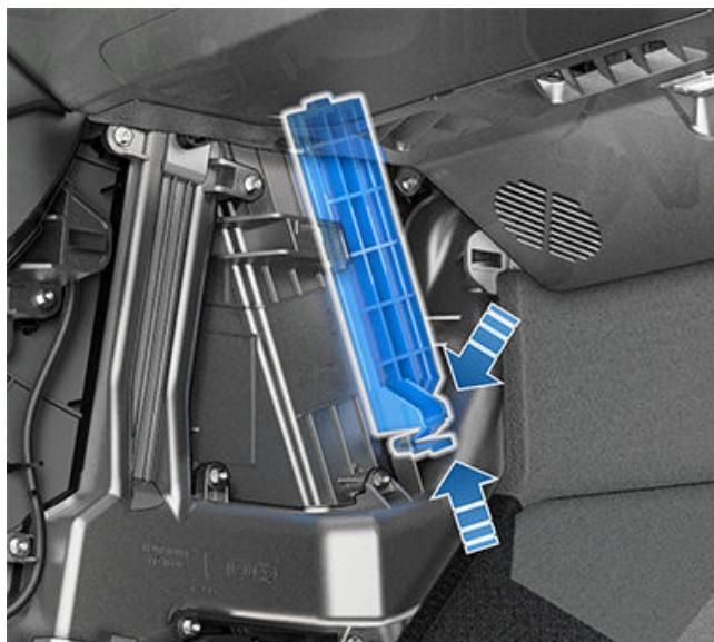
6. 向上摺疊駕駛室上部過濾器的鎖片，並向下摺疊下部過濾器的鎖片。
