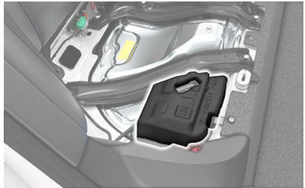
**⚠ 警告：** 座墊下方的區域裝有高壓電池。請勿在觸摸金屬外殼或在上方放置物品！這樣做可導致嚴重機件損壞或人身傷害。
