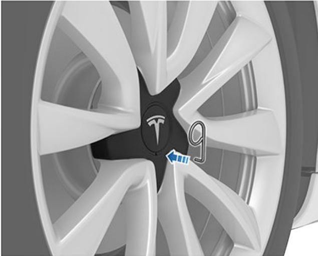
2. 操縱凸緣螺母蓋裝卸工具，將其完全插入凸緣螺母蓋的小孔內。
