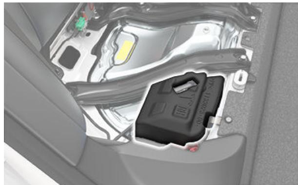
**⚠ 警告：**座墊下方的區域裝有高壓電池。請勿在觸摸金屬外殼或在上方放置物品！這樣做可導致嚴重機件損壞或人身傷害。
