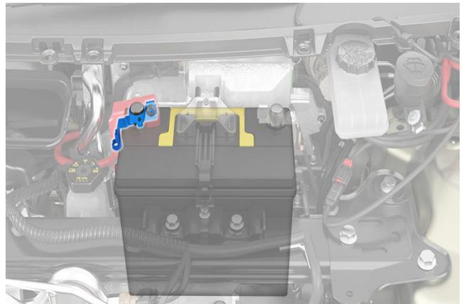
6. 將終端夾子放在連接器上以連接負極 (-) 終端。使用 10 毫米插槽，以 6 Nm (4.4 ft-lb) 的扭力擰緊螺母。
