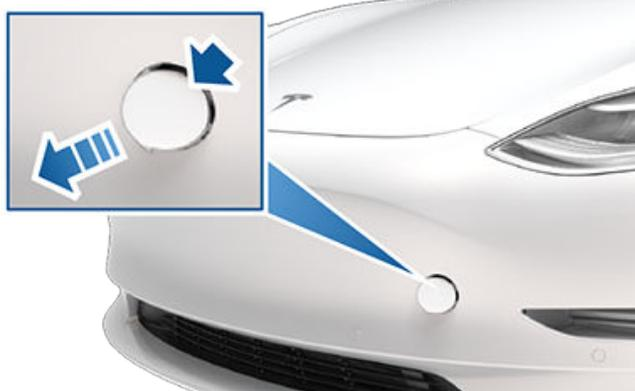
3. 將牽引環完全插入開口處，然後逆時鐘轉動，直至固定牢固。
