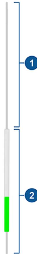
1. 顯示電池正在輸出的電量，例如用於為車輛加速。踩下加速腳踏時，電量表上半部分填充黑色（或在晚間模式時以白色填充）。
