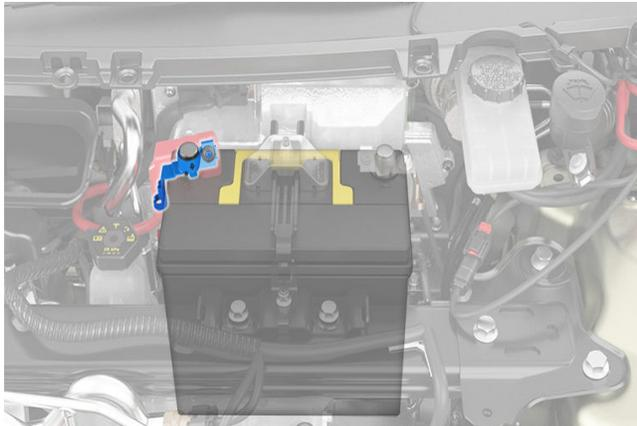
11. 從低壓鉛酸電池的負極 (-) 終端側拔下排氣軟管。
