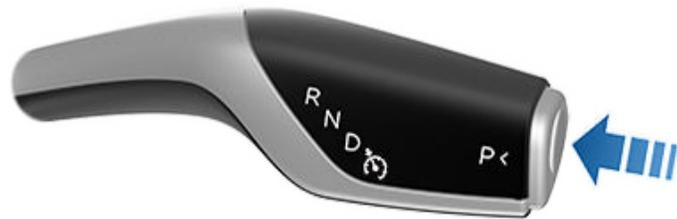
Model 3 自動換入泊車檔，以防止低速行駛時溜車。當你在前進檔或空檔時連接充電線、解開安全帶或打開車門時，便會發生此情況。換出泊車檔之前，請確保已拔出充電線、扣好安全帶並關上車門。
