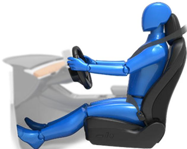
調節座椅位置，以便在盡可能遠離前部安全氣袋的同時正確佩戴座椅安全帶：
