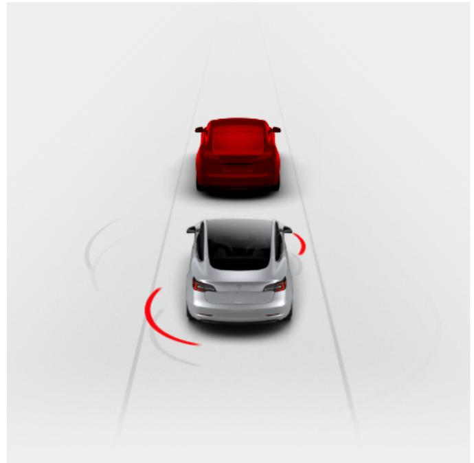
當碰撞的風險降低時（例如，你已減速或停止 Model 3，或前方障礙物已離開你的行駛路徑），視像與聲音警告會自動取消。
