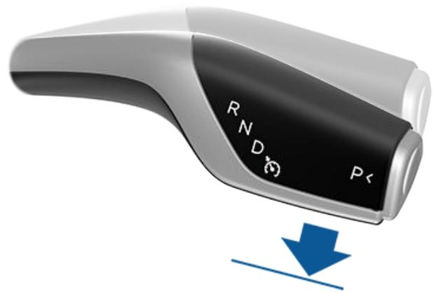
**注：**若 Autopilot 自動輔助駕駛啟用 設定為拉動一次，則向下推動駕駛桿一次亦會啟用自動輔助轉向（包括主動巡航控制）。輕觸 控制 > Autopilot 自動輔助駕駛 > Autopilot 自動輔助駕駛啟用 並選擇拉動兩次，當你將駕駛桿向下推動一次時便可使用主動巡航控制，而不使用自動輔助轉向。
