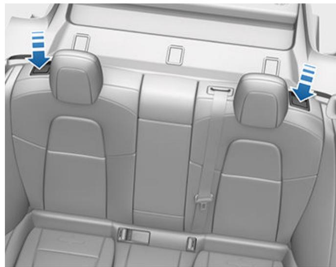
若要摺疊後排座椅，只需拉起相應的控制桿並將座椅向前摺疊。
