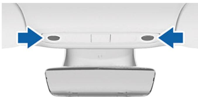
也可以透過按下燈玻璃手動開啟或關閉個別閱讀燈。如果你手動開啟車內頂燈，車內頂燈會在 Model 3 關閉電源後關閉。如果手動開啟車內頂燈時 Model 3 的電源已經關閉，車內頂燈最後也會關閉。
