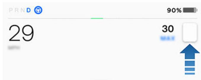
如果在 Model 3 無法確定速度限制的情況下，或者車速輔助不能確定獲取的速度限制是否準確，觸控式螢幕可能不會顯示限速標誌且警告不會生效。
