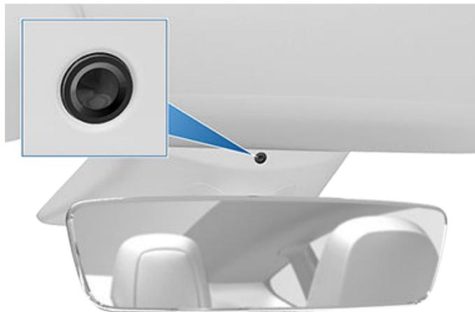
車廂鏡頭可判斷駕駛員的注意力，並提供音訊警報，以提醒你在啟用 Autopilot 自動輔助駕駛時應注視前方路面。
