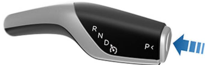
Model 3 自動換入泊車檔，以防止低速行駛時溜車。當你在前進檔或空檔時連接充電線、解開安全帶或打開車門時，便會發生此情況。換出泊車檔之前，請確保已拔下充電線、扣好安全帶並關上車門。
