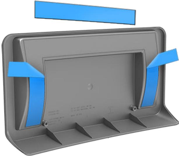
4. 傾斜車牌支架頂部使其離開保險桿（防止粘合在錯誤位置）時，對準車牌支架底部中心與格柵中部，如圖所示。
