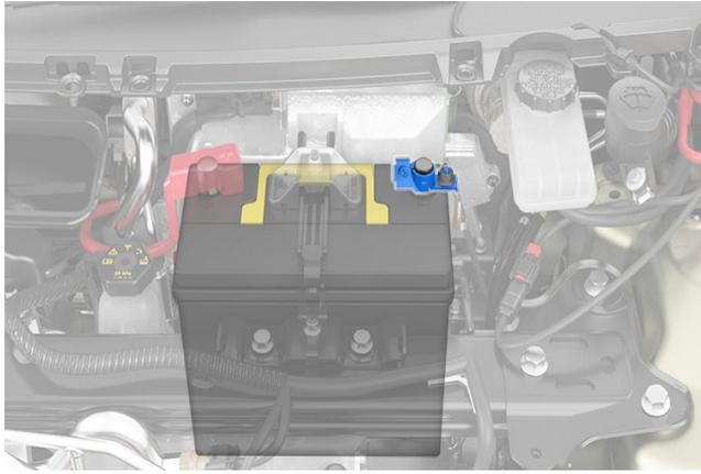
7. 將排氣軟管連接到低壓鉛酸電池的負極 (-) 終端側。
