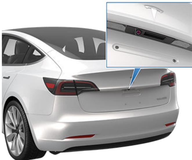
只要你切換到倒車檔，觸控式螢幕即會顯示來自鏡頭的圖像。導線會根據駕駛軀盤的位置顯示行駛路徑。這些導線會隨著你移動駕駛軀盤調整。
