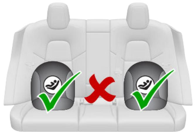
安裝門鎖兒童安全座椅，應將安全座椅插銷滑進固定桿，直到完全嵌入。請仔細閱讀並遵守兒童安全座椅製造商說明。
