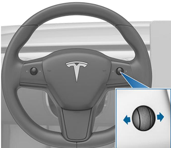
每個設定均對應一個基於時間的距離，該距離表示 Model 3 從目前位置到達前方車輛後保險桿所在位置的所需時間。Autopilot 自動輔助駕駛將保持你的設定直至你再次變更。
