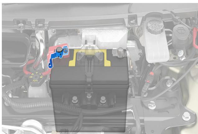
8. 從低壓電池的負極 (-) 終端側拔下排氣軟管。
