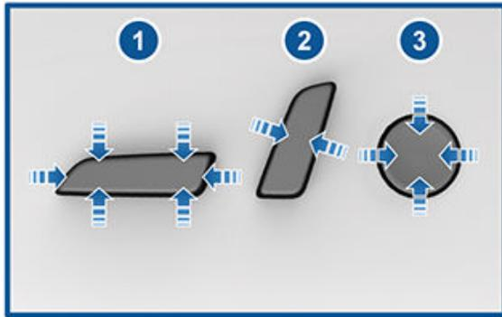
1. 前後移動座椅，調整座椅高度，上下傾斜座椅角度。
