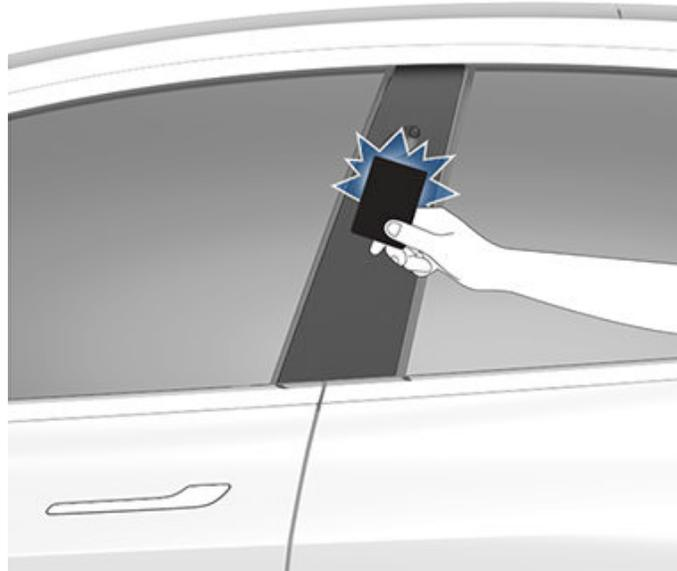
進入車內後，請在感應鑰匙卡後兩分鐘內踩下煞車腳踏以啟動 Model 3 (請參閱 [啟動及關閉電源 在第 頁 56](#))。若等待超過兩分鐘，則需重新驗證，此時請將卡片車匙放在中控台杯架後方的讀卡機附近。車輛偵測到鑰匙卡後，會重新開始兩分鐘的驗證等待時間。
