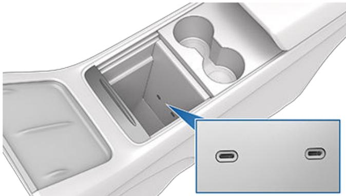
視乎生產日期而定，部分車輛的手飾箱內可能有 USB 連接埠。此 USB-A 連接埠配備已預先格式化的快閃磁碟機，可在使用哨兵模式和行車記錄儀等功能時隨時儲存影片。此連接埠還可用於與車輛通訊，以及為連接 USB 的裝置充電（但並非其主要用途）。
