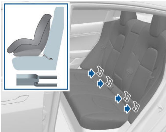
安裝後，須在兒童乘坐前測試裝置的安全性。嘗試將兒童安全座椅從一側向另一側扭動，並嘗試將其拉離座位，然後，檢查並確保固定器仍然固定到位。
