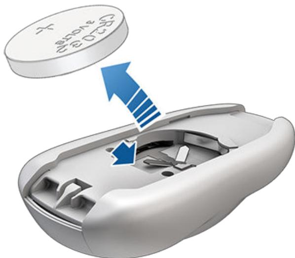
3. 在避免接觸電池的平坦表面的同時，插入新電池（型號 CR2032），使「+」面向上。
