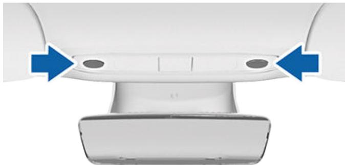
也可以透過按下燈玻璃手動開啟或關閉個別閱讀燈。如果你手動開啟車內頂燈，車內頂燈會在 Model 3 關閉電源後關閉。如果手動開啟車內頂燈時 Model 3 的電源已經關閉，車內頂燈最後也會關閉。
