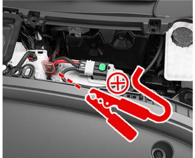
4. 將外部低壓電源的黑色負極 (-) 電纜連接至位於迫力油缸和前行李艙之間的螺釘。螺釘用作外部支撐的接地位置。
