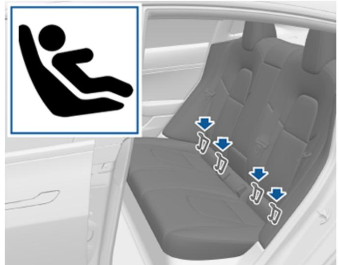
於第二排，僅在外側座位位置安裝門鎖兒童安全座椅。僅可於中座使用安全帶固定式座椅。
