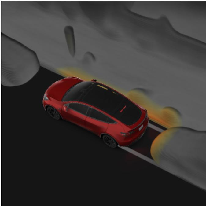
視像顏色與 Model 3 和所顯示物體之間的距離相對應。紅色表示離 Model 3 較近，黃色則表示離 Model 3 較遠。
