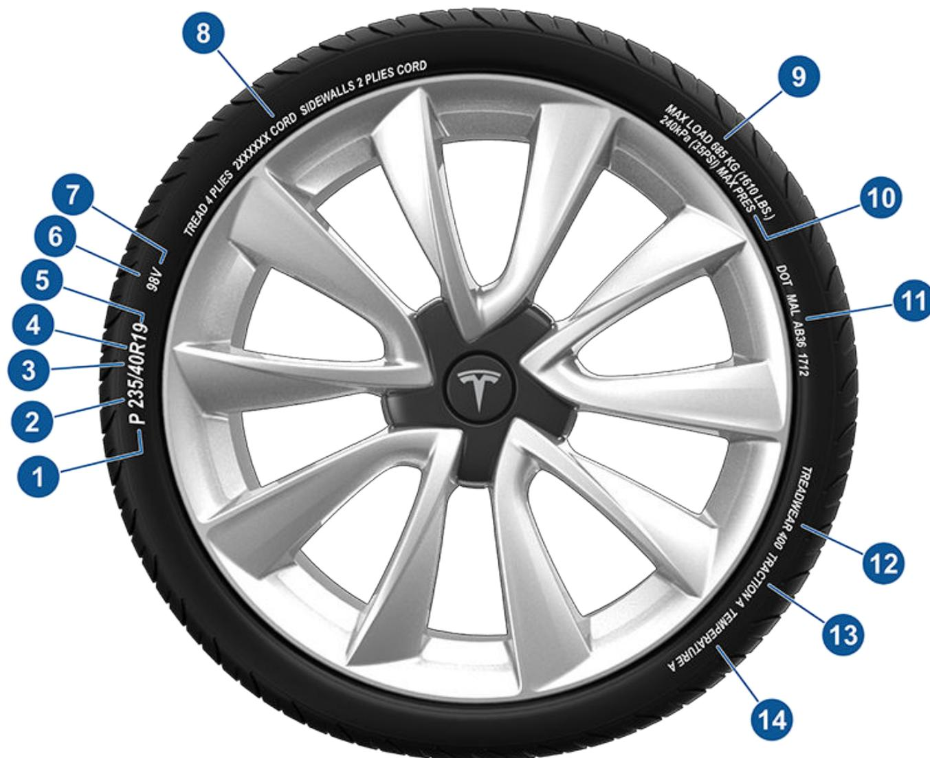
注：你可透過輪胎側壁上的「T 標記」規格（例如 T0、T1、T2）來識別 Tesla 認可的輪胎。Tesla 認可的輪胎旨在配合你的車輛使用並優化性能、安全性、可靠性和耐用性。如需進一步了解 Tesla 認可的替換輪胎，請參閱維修手冊。
