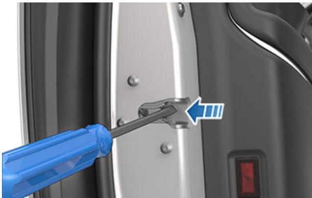
2. 確保 Model X 已解鎖，然後按下外部車門把手或拉動內部車門把手，以重設門鎖並伸出彈出驅動器。
