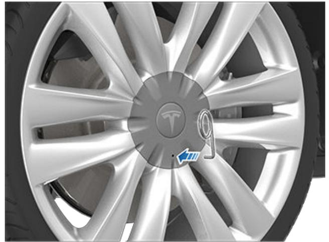
2. 操縱凸緣螺母蓋裝卸工具，將其完全插入凸緣螺母蓋的小孔內。
