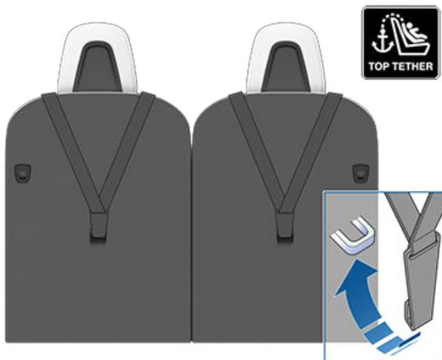
將單固定繫帶放置於高過頭部保護裝置外側的外側座椅處（即與安全帶縮回機制同側）。在中央座椅位置（如有配備），將繫帶置於中間並繞過頭部保護裝置的頂部。
