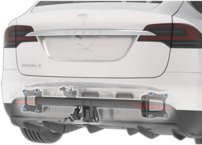
**注：**拖車連接點的最大允許後懸為 47 英寸 (1186 mm)。
