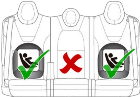
**注：**如要放置大型後向式 LATCH 兒童安全座椅，可能需要將座椅移至完全靠後的位置，並且將對應的前排座椅移至導軌中段位置（最靠後位置的前側最多 13 公分處），向上升高座椅（從其最低位置升高 3 公分），並將座椅向後傾斜 15 度（或從其最靠前位置向後移動 10 度）。
