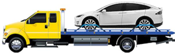
如果 Model X 必須在沒有平板拖車的情況下運輸，則必須使用車輪舉升器與推車來確保所有 4 個車輪都離開地面。此方法可使用最長距離為 35 英哩或 55 公里，並且不得超過製造商對推車的車速等級。透過這方法，Tesla 建議車輛面向前方，以便提升前輪，後輪安置在推車上。
