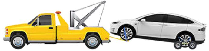
**警告：** 啟用運輸模式（請參閱 [啟動運輸模式](#) 在第 頁 217），然後才將 Model X 吊到平板拖車上（請參閱 [拉至平板拖車上 - 使用牽引環](#) 在第 頁 218）。如果無法使用運輸模式或觸控式螢幕，則必須使用自動裝載推車或輪胎滑板將車輛裝載到批准的運輸位置。對於因運送 Model X 或運送期間造成的任何損壞，包括因使用自動手推車或輪胎滑板造成的個人財物等損失，Tesla 概不負責。
