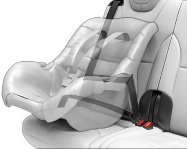
2. 縮回座椅安全帶，並且在將兒童安全座椅牢牢推入 Model X 座椅的同時，收緊鬆弛的座椅安全帶。
