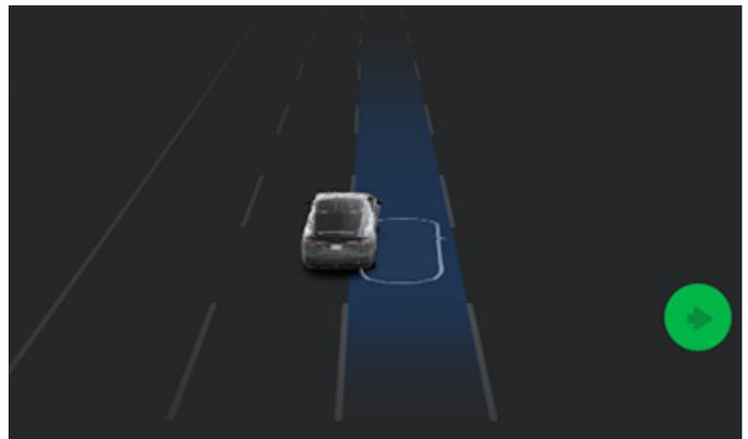
Quando o painel de instrumentos apresenta uma mensagem que solicita que confirme a mudança de faixa, acione o sinal de mudança de direção adequado ou puxe o manípulo do Piloto Automático para si. Se não confirmar a mudança de faixa no espaço de três segundos, é emitido um sinal sonoro para o recordar de que a funcionalidade Navegar em Piloto Automático requer que confirme a mudança de faixa.
