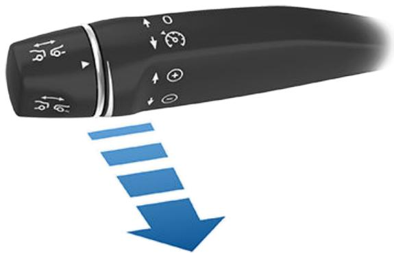
**NOTA:** Se a **Ativação do Piloto Automático** estiver definida para **Puxar uma vez**, deslocar o manípulo do Piloto Automático na sua direção uma vez ativa a **Direção Automática** (consulte [Direção Automática na página 141](#)). Toque em **Controlos > Piloto Automático > Ativação do Piloto Automático** e selecione **Puxar duas vezes** para utilizar o Cruise Control Adaptativo de forma independente da **Direção Automática** quando desloca a alavanca da **Direção Automática** na sua direção.
