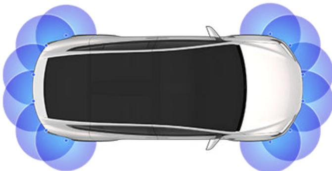
**NOTA:** O auxiliar de estacionamento pode ser desativado quando é detetada uma bicicleta ou quando o Model X está no modo de reboque.
