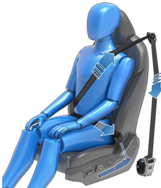
Se os pré-tensores e os airbags não se ativarem em caso de impacto, isto não significa que estejam avariados. Normalmente, significa que a intensidade ou o tipo de força necessária para os ativar não estavam presentes.
