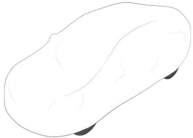
**AVISO:** Utilize apenas uma cobertura para automóvel aprovada pela Tesla quando o Model X estiver ligado à corrente. A utilização de uma cobertura para automóvel que não seja da Tesla pode impedir o arrefecimento adequado da bateria durante o carregamento.
