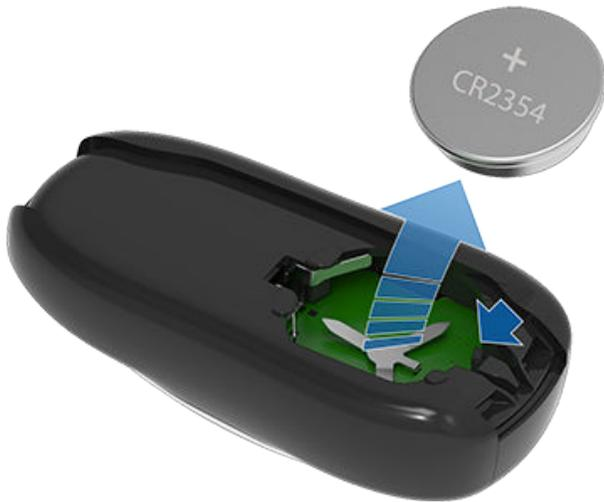
3. Coloque a pilha nova (tipo CR2354) com o lado + virado para cima. A pilha deve encaixar perfeitamente, pelo que deve fazê-la deslizar na diagonal na direção do contacto positivo (o contacto situado perto do centro do comando) e, em seguida, empurrá-la firmemente para baixo no outro lado, assegurando-se de que está bem fixa na posição pretendida.
