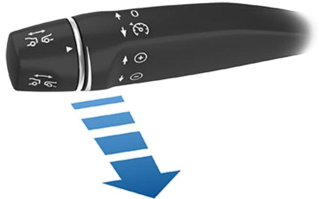
**NOTA:** Se a definição de **Ativação do Piloto Automático** estiver definida para **Puxar uma vez** (toque em **Controlos > Piloto Automático > Ativação do Piloto Automático**), a Direção Automática ativa-se quando puxa o manípulo do Piloto Automático na sua direção uma vez. Se definida para **Puxar duas vezes**, tem de puxar o manípulo do Piloto Automático na sua direção duas vezes numa sucessão rápida para ativar a Direção Automática.
