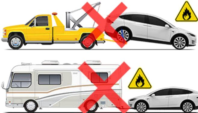
Não transporte o Model X utilizando outros métodos que não os especificados pela Tesla. Cumpra as instruções fornecidas nas seções seguintes e respeite todos os avisos e precauções fornecidos. Os danos causados pelo transporte inadequado do veículo não são abrangidos pela garantia.
