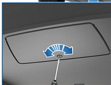
2. Insira a chave no cilindro de bloqueio no engate e rode o cilindro de forma a que a parte superior da chave esteja alinhada com a posição de "desbloqueio".
