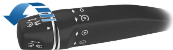
À medida que roda o manípulo do piloto automático, o painel de instrumentos apresenta a definição atual. Solte o manípulo quando a definição pretendida for apresentada.
