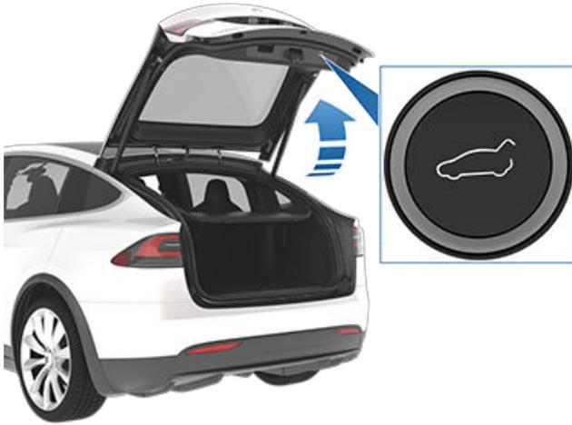
3. Confirme se a definiu para a altura pretendida fechando a porta da bagageira e voltando a abrir.
