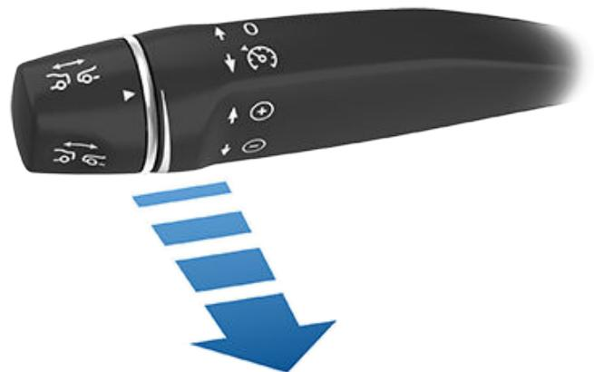
Para retomar a velocidade de cruzeiro à velocidade de condução atual, desloque o manípulo do Piloto Automático para cima ou para baixo e, em seguida, solte-o.
