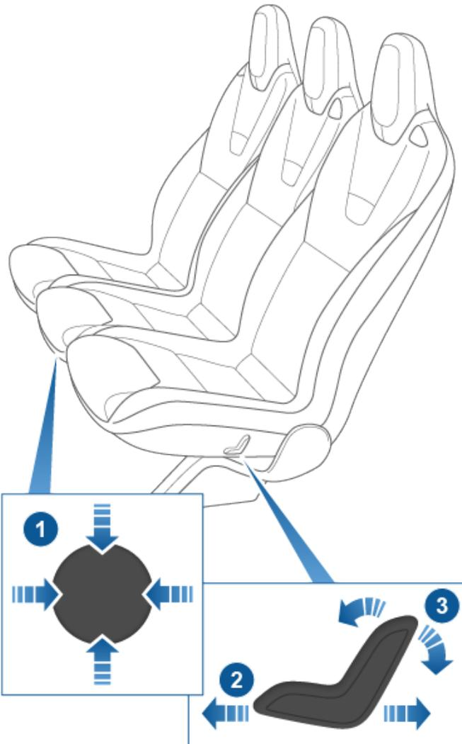
1. Desloque o banco para a frente/para trás (para cima/para baixo no controlo) e ajuste o encosto (para a esquerda/para a direita no controlo).
