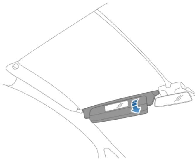
Para proteger os ocupantes do banco dianteiro da luz solar que entra através dos vidros laterais, baixe a pala do pilar e, em seguida, baixe o extensor da pala.
