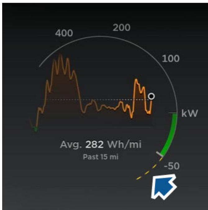
**NOTA:** Se a travagem regenerativa abrandar o Model X de forma brusca (por exemplo, quando o seu pé está completamente fora do pedal do acelerador a altas velocidades), as luzes de travagem acendem para alertar os outros utentes da estrada de que está a abrandar.
