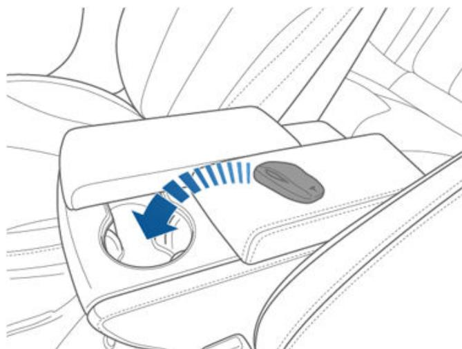
Se o Model X continuar a não detetar o comando, experimente colocá-lo contra a consola central, imediatamente abaixo da tomada de alimentação de baixa tensão (consulte [Baixa tensão Tomada de alimentação na página 10](#)). Se ainda assim o comando não for detetado,
