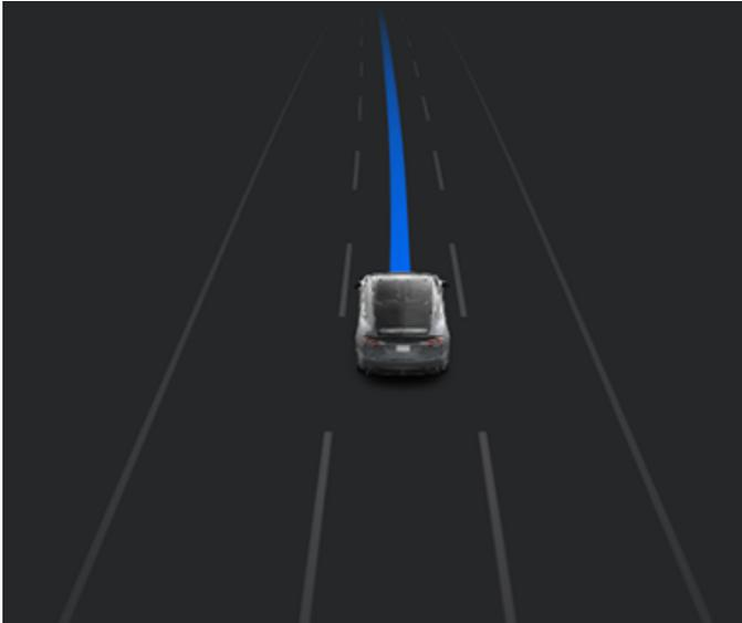
Quando a funcionalidade Navegar em Piloto Automático está ativa e se aproxima de uma rampa de saída ou de uma ligação do seu itinerário de navegação, o sinal de mudança de direção relevante é acionado e a Direção Automática realiza as manobras do Model X para o direcionar para a rampa de saída ou ligação.
