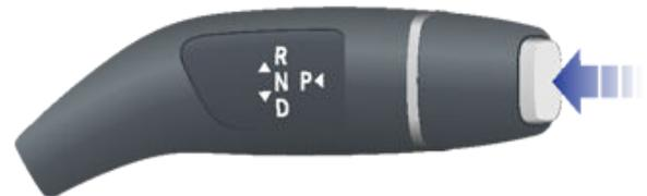
Model X muda automaticamente para a posição de estacionamento para evitar o deslizamento durante a condução a baixa velocidade. Isto acontece sempre que liga um cabo de carregamento, desaperta o cinto de segurança ou abre a porta enquanto se encontra na posição de condução ou de ponto-morto. Certifique-se de que o cabo de carregamento foi removido, aperte o cinto de segurança e feche a porta antes de sair da posição de estacionamento.
