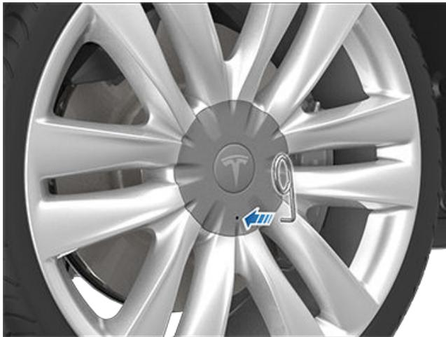
2. Coloque a ferramenta da tampa de porca de ressalto de forma a ficar totalmente inserida no orifício na tampa de porca de ressalto.
