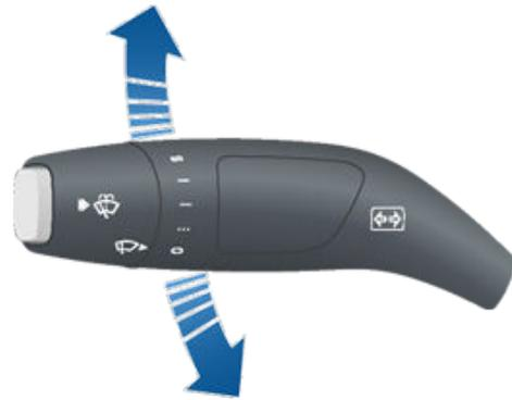
Os sinais de mudança de direção são cancelados pelo volante ou quando volta a colocar a alavanca na posição central.
