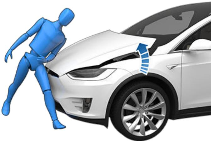
Se o capô ativo tiver sido acionado, o painel de instrumentos apresenta um alerta e ouve-se um sinal sonoro. Leve imediatamente o Model X ao centro de assistência da Tesla ou à oficina aprovada pela Tesla mais próximo(a). Os sensores e atuadores associados ao capô ativo têm de ser verificados sempre que ocorra um acionamento do capô ativo.
