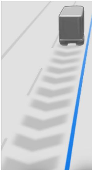
Se estiver a seguir um veículo, o Piloto Automático mantém-se ativo a velocidades baixas, mesmo quando o Model X se imobiliza. Por exemplo, o Piloto Automático permanece ativo mesmo se o Model X abrandar até ficar total ou quase totalmente imobilizado em tráfego intenso e congestionado numa autoestrada. Quando o tráfego se começar a movimentar mais rapidamente, o Piloto Automático volta a acelerar até à velocidade definida.
