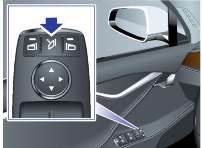
Quando recolhe manualmente os espelhos, estes permanecem rebatidos até atingir uma velocidade de 50 km/h (ou até abri-los manualmente).
