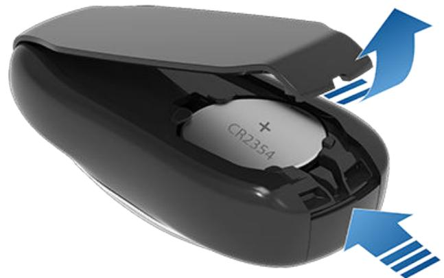
**NOTA:** Se houver uma correia presa ao comando, pode soltar a tampa inferior colocando o polegar contra o "X" na tampa inferior e, em seguida, puxando a correia para si com firmeza (retirando assim o comando da respetiva tampa). Também pode retirar a tampa colocando uma pequena ferramenta de lâmina plana, uma unha, ou a ferramenta fornecida pela Tesla contra o cordão da correia.
