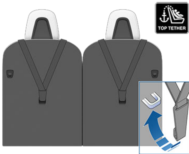
Cinghie di stabilizzazione doppie - Sedili della terza fila:
