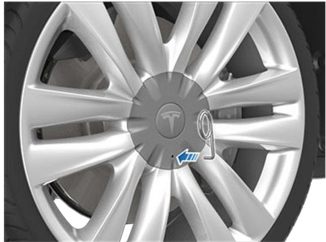
2. Mueva la herramienta para cubiertas de tuercas hasta que esté totalmente insertada en el orificio de la cubierta de la tuerca.
