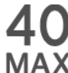
Cuando el Control de cruceo adaptado al tráfico está disponible pero no activado, la panel de instrumentos muestra un icono de velocidad de color gris. El número que se muestra representa la velocidad que se establecerá al activar el Control de cruceo adaptado al tráfico.
