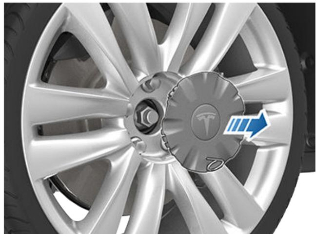
Para instalar la cubierta de una tuerca:
