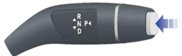
Model X cambia automáticamente a Estacionamiento para evitar rodaje durante la conducción a baja velocidad. Esto ocurre siempre que se conecta un cable de carga, se desabrocha el cinturón de seguridad o se abre la puerta estando en una marcha de avance o en punto muerto. Asegúrese de retirar el cable de carga, abrocharse el cinturón de seguridad y cerrar la puerta antes de quitar la marcha del modo de Estacionamiento.
