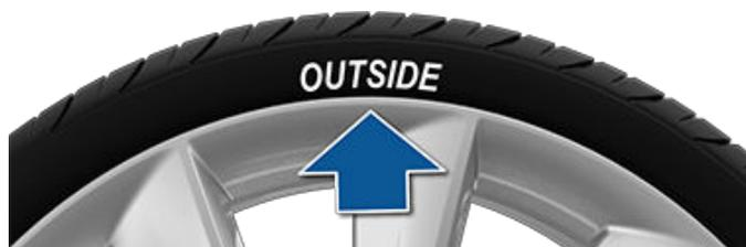
**⚠ AVISO:** La estabilidad puede verse gravemente afectada si los neumáticos no se instalan correctamente en las llantas.
