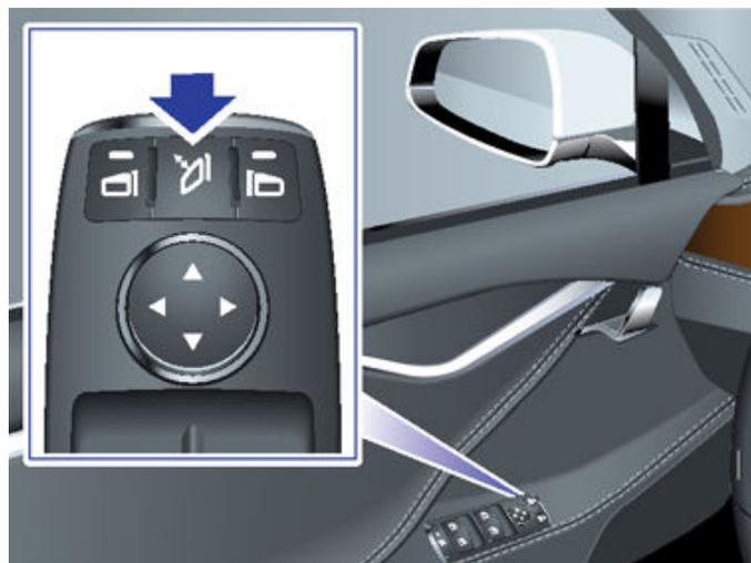
Al plegar manualmente los retrovisores, permanecerán plegados hasta que su velocidad de conducción alcance los 31 mph (50 km/h) (o hasta que los despliegue manualmente).
