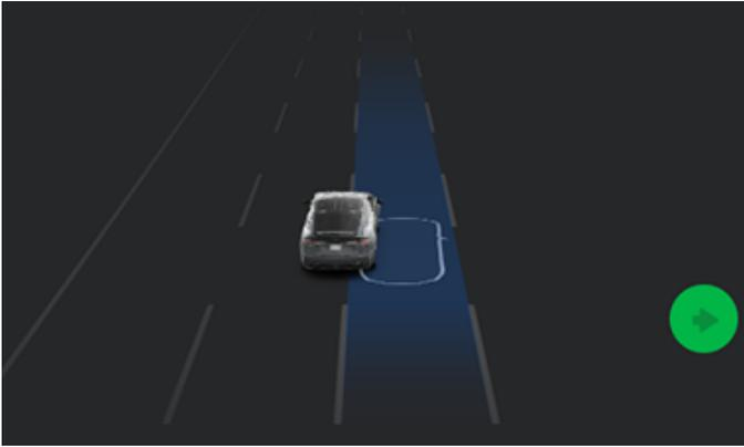
Si el ajuste **Requiere confirmación de cambio de carril** está **desactivado**, Navegar en Piloto automático activa el intermitente correspondiente, comprueba si hay vehículos y objetos y, cuando corresponde, maniobra el Model X hacia el carril adyacente.
