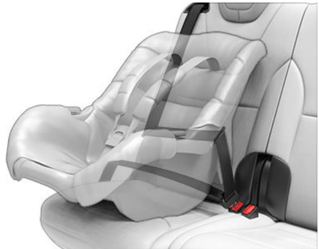
2. Deje que el cinturón de seguridad se retraiga y ajuste mientras empuja con firmeza el asiento de seguridad infantil hacia el asiento del Model X.
