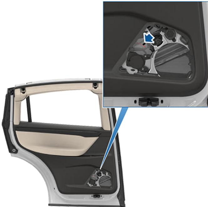
**⚠ PRECAUCIÓN:** La apertura manual de las puertas solo se debe utilizar en caso de que el Model X no tenga carga. Cuando el Model X tenga electricidad, utilice el botón situado en la parte superior del tirador interior de la puerta.
