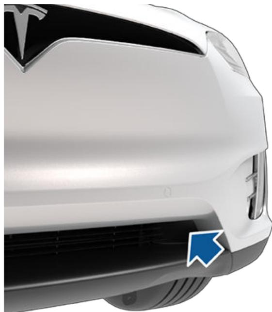
**NOTA:** Guarde la tapa de la anilla de remolque en un lugar seguro para volver a colocarla una vez terminado el proceso de remolque.
