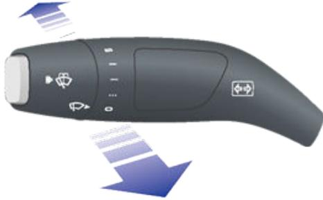
Las luces largas pueden cambiar automáticamente a luces de cruce si se detecta luz delante del Model X (por ejemplo, procedente de un vehículo circulando en dirección contraria). Para activar o desactivar esta función, toque **Controles > Luces largas automáticas** o **Controles > Luces > Luces largas automáticas**.
