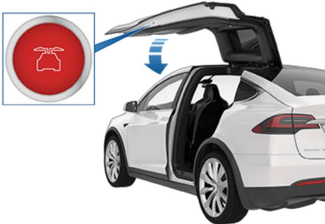
Si una puerta de ala de halcón se dejan abiertos cuando intenta quitar la posición de estacionamiento, la pantalla táctil mostrará un aviso pidiéndole que confirme su intención de conducir. La puerta de ala de halcón se cierra automáticamente cuando la velocidad de conducción alcanza 10 mph (16 km/h). Es su responsabilidad asegurarse de que las puertas y los maleteros están cerrados antes de comenzar a conducir.
