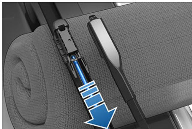
7. Sujete el brazo del limpiaparabrisas y presione la pestaña de bloqueo mientras desliza la escobilla por el brazo.
