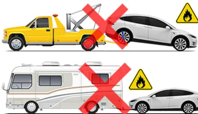
No transporte el Model X utilizando ningún método que no esté especificado por Tesla. Siga a las instrucciones proporcionadas en las siguientes secciones y observe todas las advertencias y precauciones proporcionadas. El daño causado por un transporte inadecuado del vehículo no está cubierto por la garantía.
