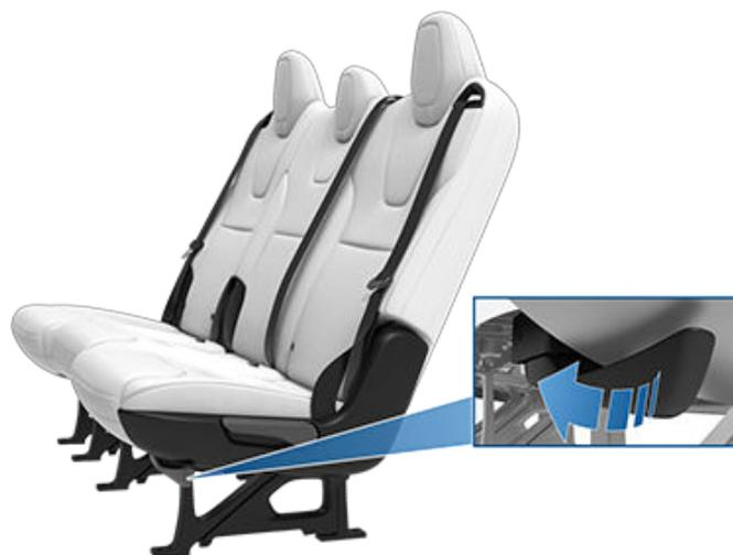
**NOTA:** Usted puede ajustar la posición de los asientos múltiples utilizando solo las palancas mecánicas. No puede utilizar la pantalla táctil para ajustar los asientos múltiples.
