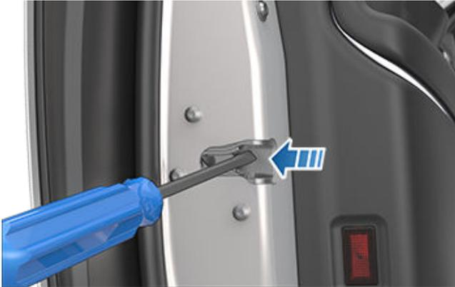
2. Asegúrese de que el Model X no tenga los seguros puestos; a continuación, presione el tirador exterior de la puerta o tire del tirador interior de la puerta para restablecer el cierre y así extender el actuador.
