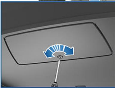
2. Introduzca la llave en el cilindro de la cerradura del enganche y gire el cilindro hasta que la parte superior de la llave quede alineada con la posición de apertura.
