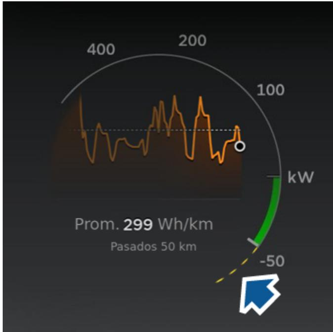
**NOTA:** Si el freno regenerativo reduce la velocidad del Model X de forma pronunciada (por ejemplo, cuando suelta completamente el pedal del acelerador a altas velocidades), las luces de freno se encenderán para avisar a los demás vehículos de que está reduciendo la velocidad.
