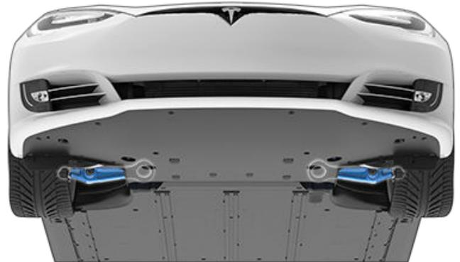
2. Para proteger la parte inferior de la carrocería contra daños, coloque una barrera activa (como una pieza de madera) entre la correa de remolque y la parte inferior de la carrocería.
