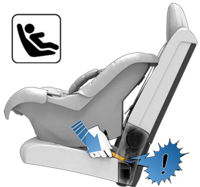
Una vez instalado, compruebe la seguridad de la instalación antes de sentar a un niño. Intente tirar del asiento de seguridad para niños y girarlo lateralmente, y compruebe que los anclajes estén firmemente sujetos en su lugar. Si el sistema de retención infantil se separa del asiento, los enganches no están bien encajados en las barras de anclaje.
