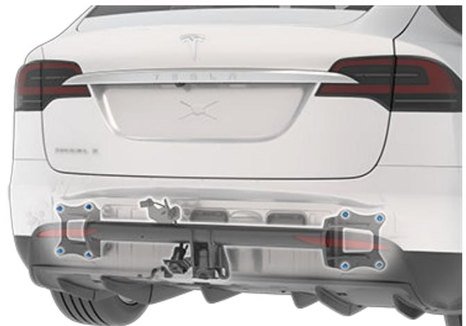
**NOTA:** El saliente trasero máximo admisible en el punto de acoplamiento es de 47 pulgadas (1186 mm).
