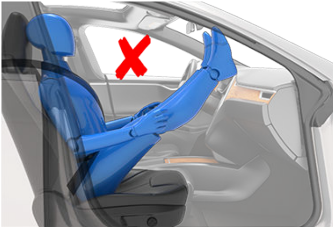
Position assise incorrecte ; le passager doit s'asseoir bien droit sur l'assise du siège :
