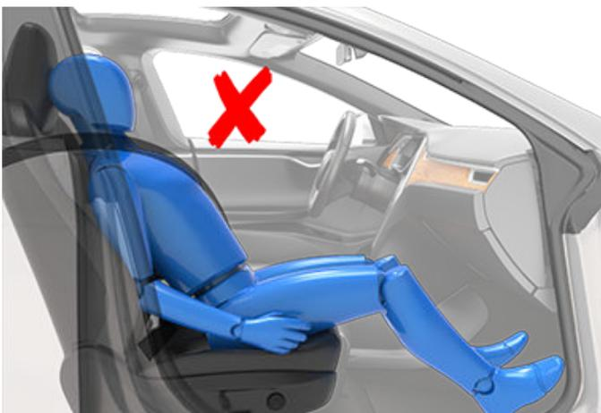
**Position assise incorrecte ; le passager ne doit pas incliner le dossier pour s'allonger lorsque le véhicule est en mouvement :**
