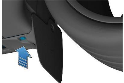
7. 將打開（塑膠鉚釘已拔出）的新固定夾安裝到輪拱內襯的孔洞中，然後向內推塑膠鉚釘，以關閉固定夾。
