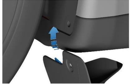
6. 將打開（塑膠鉚釘已拔出）的新固定夾安裝到下側門門檻板上的孔中，然後向內推塑膠鉚釘，以關閉固定夾。
