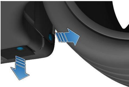
5. 移動擋泥板，使背面的塑膠鉤固定在車輪內襯下方，確保擋泥板準確對齊固定夾孔洞。
